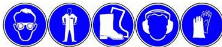
Fig. B.11. Senyalització dels equips de protecció: Ulleres, roba, calçat, protecció auditiva i guants.
