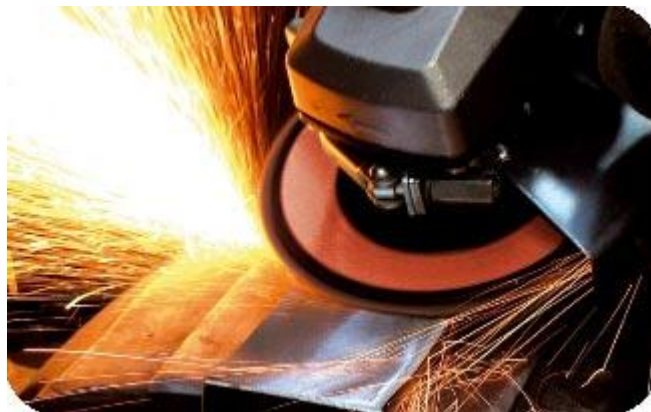
Fig. B.2. Projecció de partícules incandescentes en operacions de xapa
