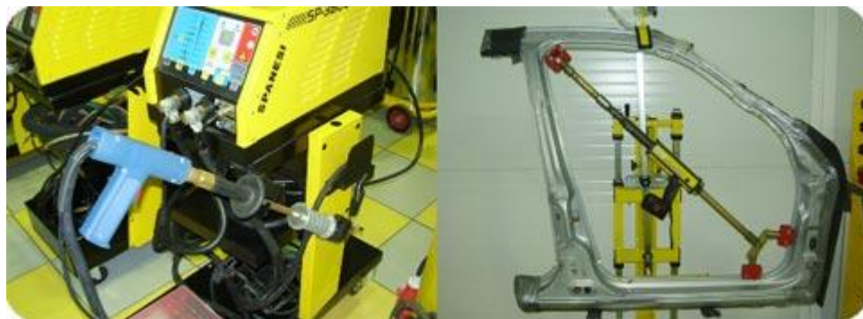
Fig. B.4. a) Màquina per reparar danys en la xapa "Saponda" b) Gat hidràulic
