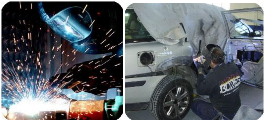
Fig. B.1. Exposició a les radiacions de llum del procés de soldadura
