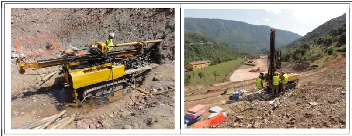
Figura 18. Fotografías de la maquinaria (Rolatec RL 48 L) en la zona de emplazamiento. (Estudio geotécnico)
