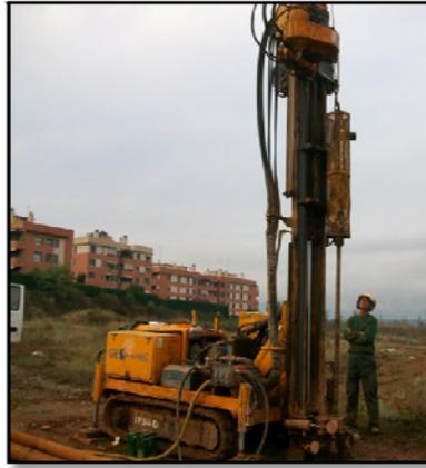
Figura 2. Fotografía de sondeo a rotación (fuente propia)
