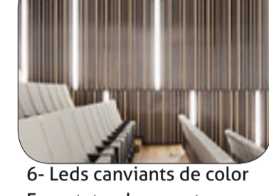
6 - Leds canviants de color Encastats a les parets Il·luminació indirecta interior
