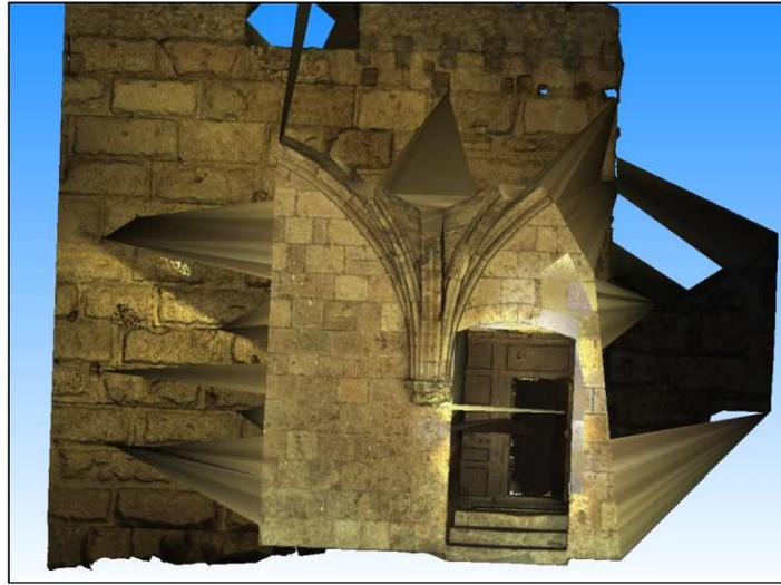
Imagen 4.7: Proceso de obtención del modelo. Mallado con textura de color de píxel
