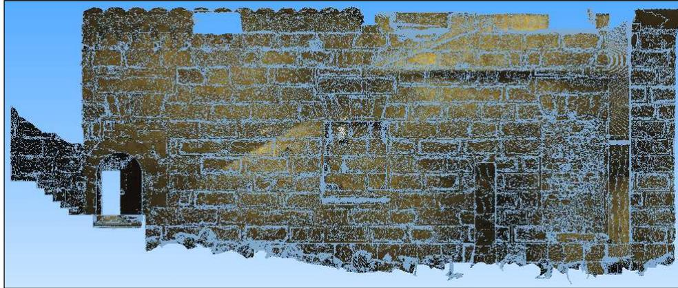
Imagen 5.4: Secciones frontales al muro romano en forma de curvas de nivel verticales
