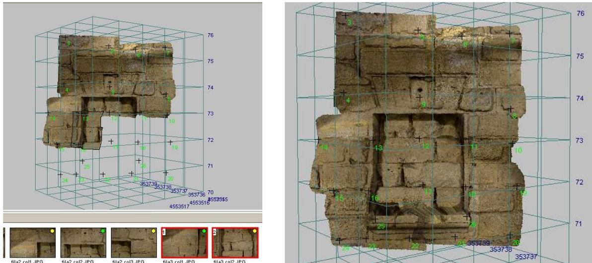
Imagen 4.12: Texturización de la superficie generada en un par estereoscópico hasta su resultado final del objeto 3D realizado con Image Master
