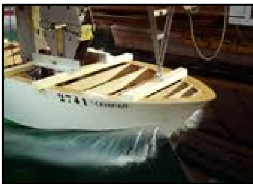
Figura 12: Ensayos de buque en canal.
