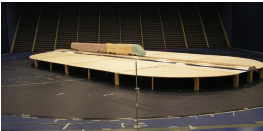
Fig. 5.2. Prova experimental en túnel de vent: model d'ETR500 a escala 1:10 sobre pis pla amb balast i rails. Font: Journal of Wind Engineering & Industrial Aerodynamics
