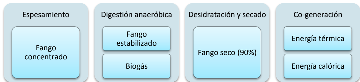
Figura 4.5 Diagrama de proceso de la línea de fangos
