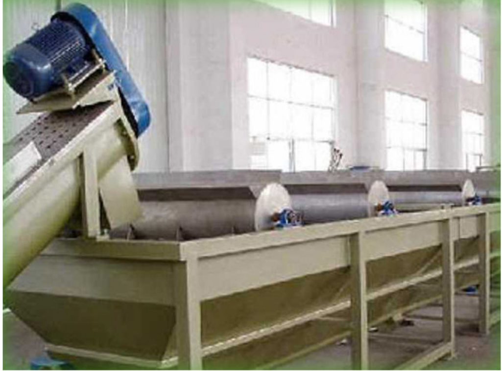
Figura 5.15: Línea de lavado y separación del plástico
