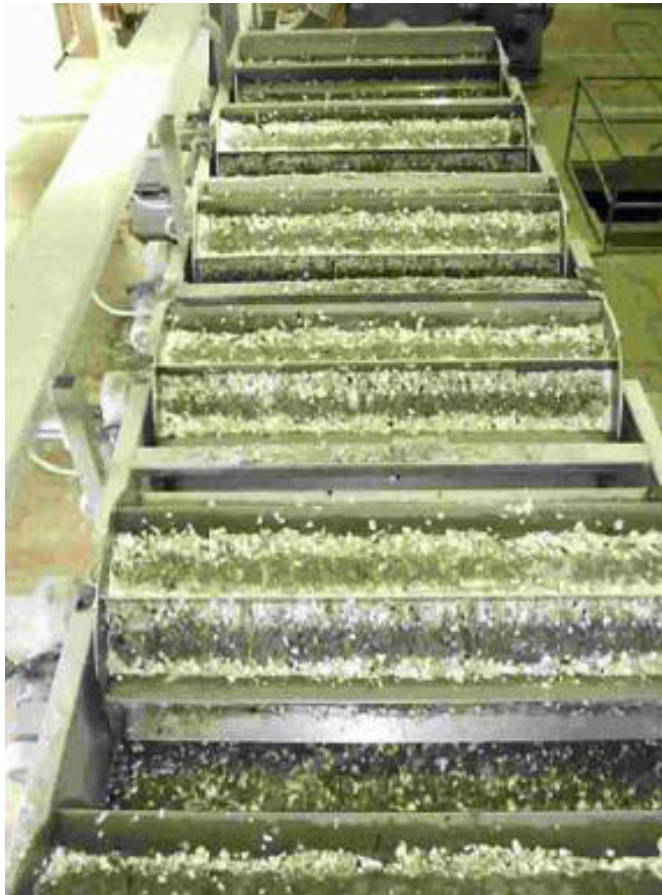
Figura 5.15: Línea de lavado y separación del plástico
