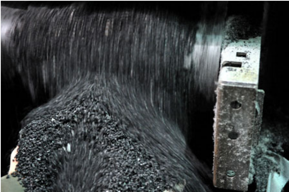
Figura 5.6: Vista del almacenaje del material en un silo mediante cinta de alimentación
