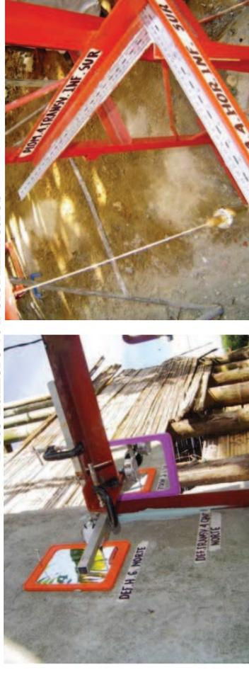
Se utilizaron deformímetros mecánicos (foto izquierda) y plomada y reglas (foto derecha), para medir los desplazamientos de la vivienda durante el ensayo.
