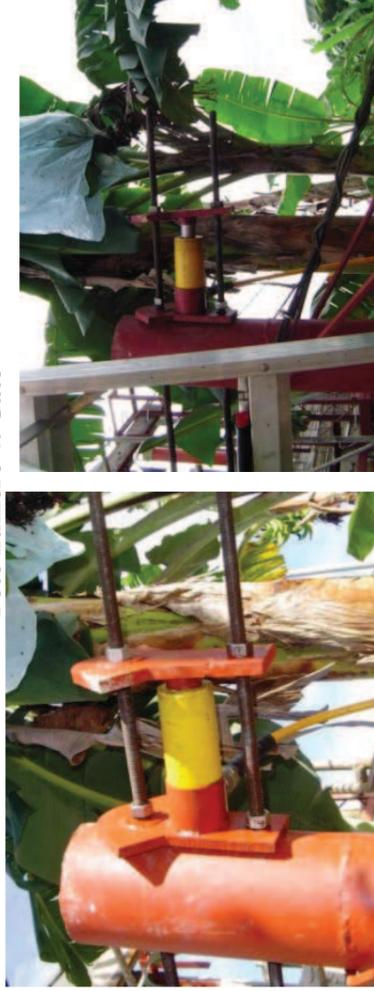
El gato de aplicación de carga tiene una capacidad de 12 ton, y permite el recalce cada que alcanzaba la longitud máxima del émbolo.
