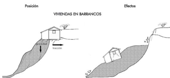
Figure 3.9. Forces in hillsides on buildings. Wilfredo Carazas, A., Rivero Olmos, A., (2002), BAHAREQUE: Guía de construcción parasísmica.
