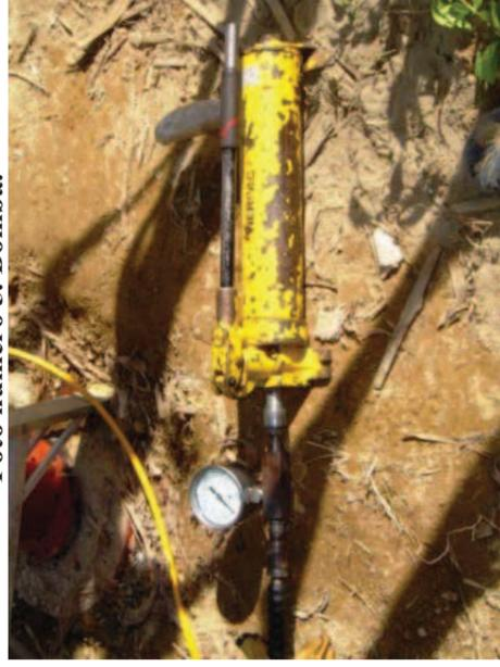
Bomba manual con manómetro en p.s.i. para la medición de la presión de carga
