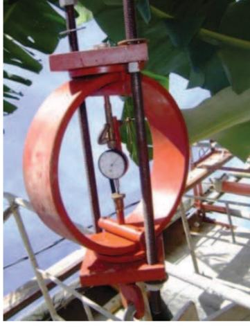
Este tensor era el responsable de transmitir la carga aplicada por el gato a la cercha, en su recorrido tenía un aro en el cual se tomaban deformaciones para constatar la calibración del gato
