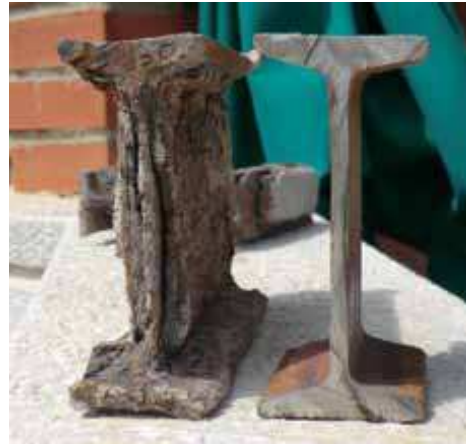
Imatge 135: Comparació entre una secció malmesa i una secció en bon estat
