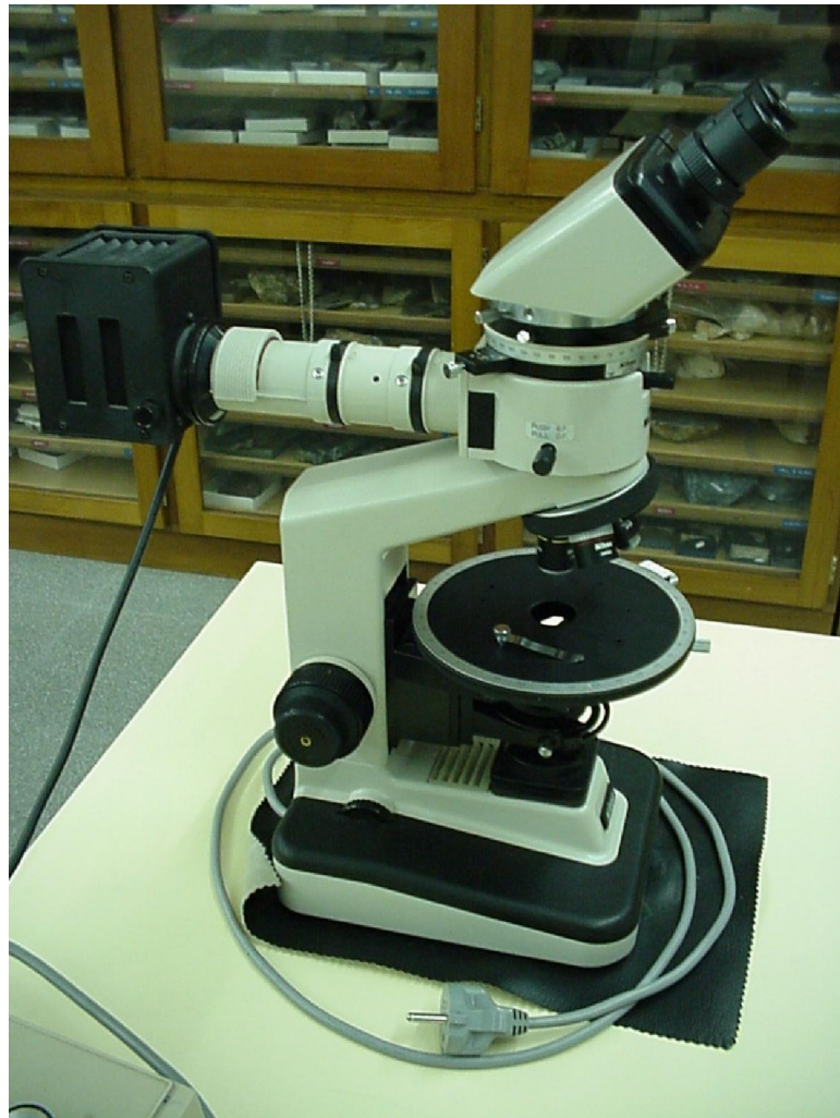
Fig. 4.2: Microscopio óptico de luz transmitida y de luz reflejada (Facultad de Geología de la Universidad de Barcelona)
