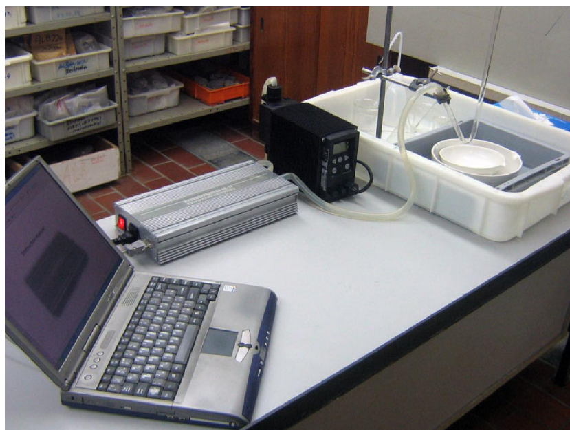
Fig. 2.7: Disposición típica de un hidroseparator (CNT-MC Corp.)
