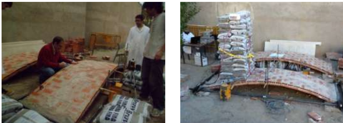
Monitorización y pruebas de carga sobre la bóveda "modelo 4"
