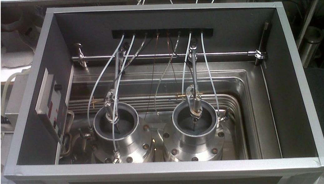
**Figura 3.12** Configuración interna en el refrigerador durante la etapa de consolidación.
