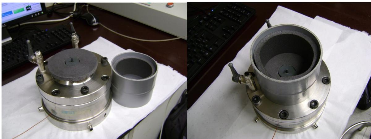
**Figura 3.9** Aislamiento zona de contacto vástago del pistón-LVDT con sección de PVC y revestimiento interno de polietileno.
