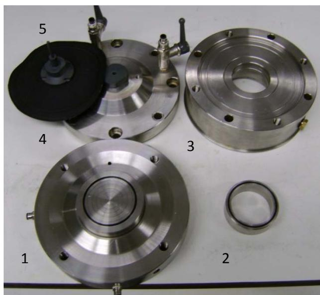
**Figura 3.5** Partes de la célula edométrica con control de secado e inundación. Laboratorio de Geotecnia, UPC.
