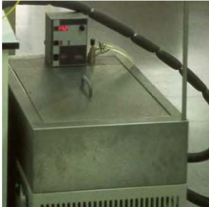
**Figura 3.2** Equipo refrigerador Hetofrig Modelo DT 1 CB 8-30. Laboratorio de Geotecnia, UPC.
