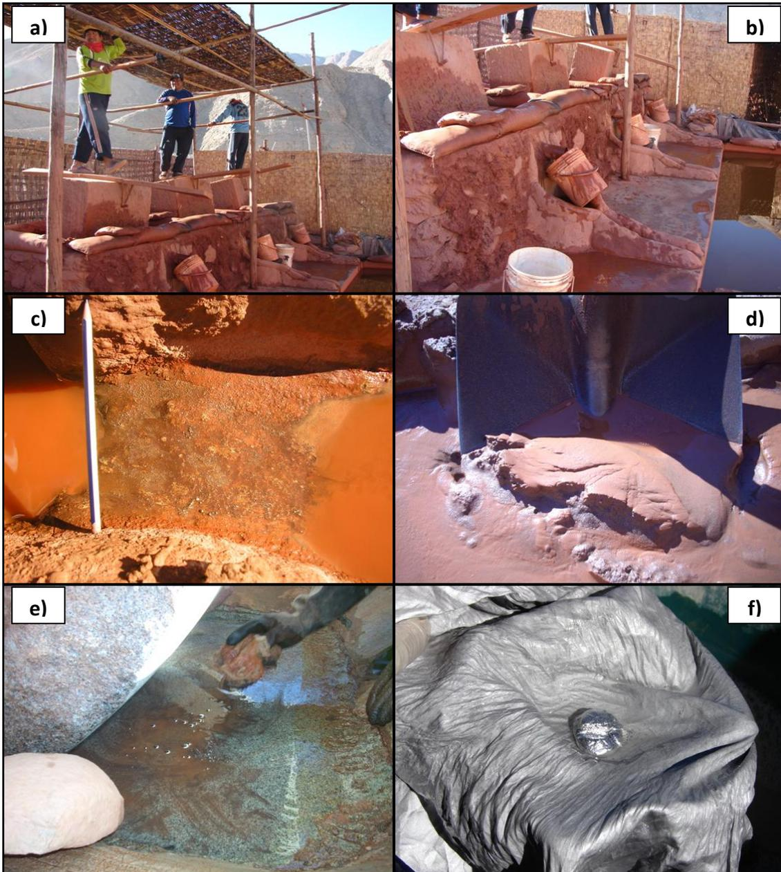
Figura 26. a) *Quimbaletes* en funcionamiento; b) Estanque de *relaves* junto a los molinos; c) Conducto por donde circula el *relave* para ir a desembocar al estanque, se ven pequeñas gotas de mercurio (puntos grises brillantes); d) *Relave* sedimentado; e) Recogida del mercurio con el oro de los *quimbaletes* una vez vaciados; f) Bola de amalgama de mercurio + oro.
