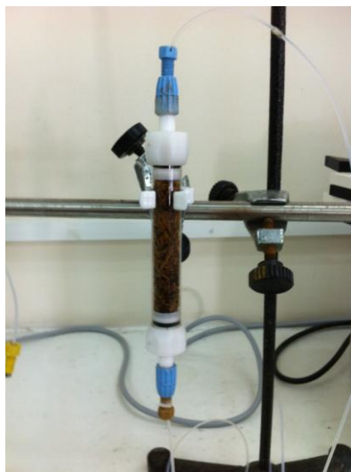
Figura C.1. Columna de biosorción montada con raspo de uva en el
