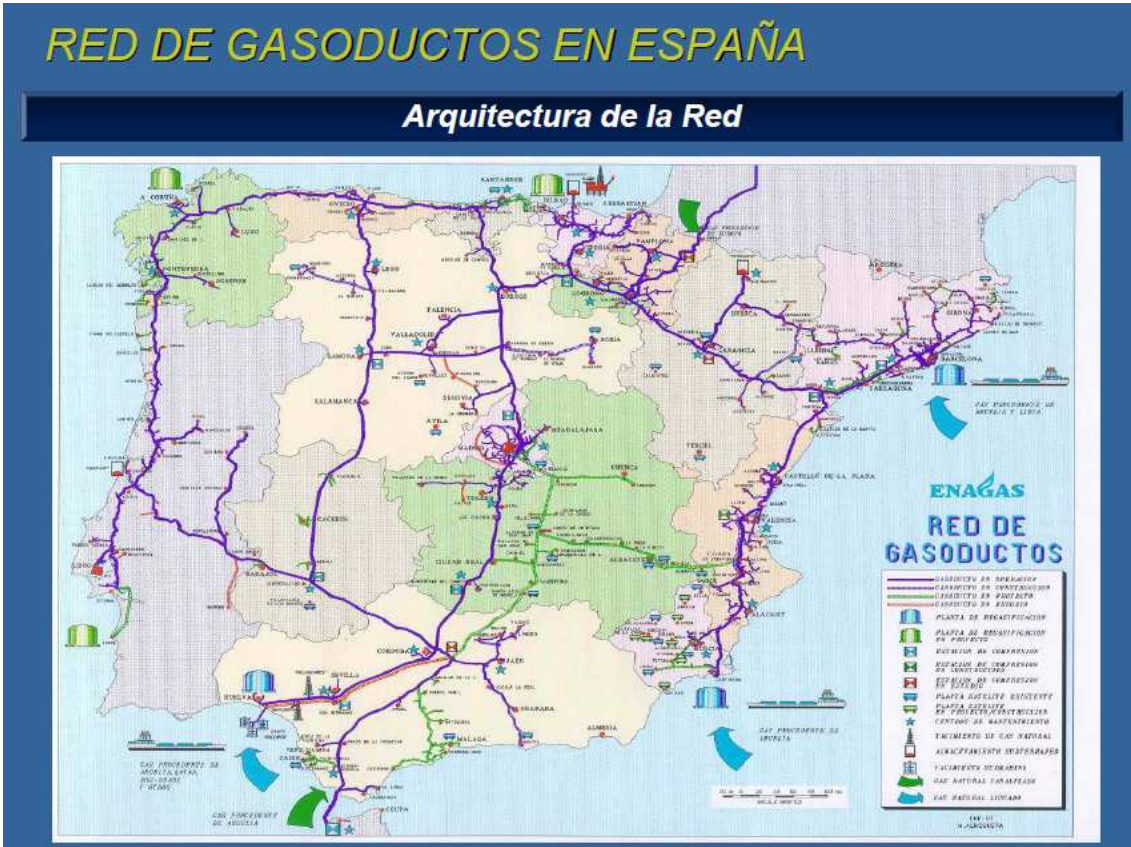
2.9- Red de gaseoductos en España, fuente Enagas.
