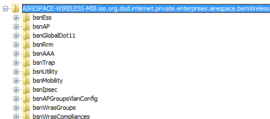
Fig. 3.8. SNMP parameters of a Cisco controller
