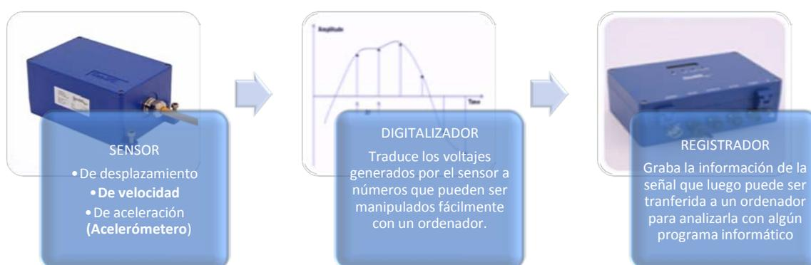
Figura 4.3: Partes generales de un sismógrafo
