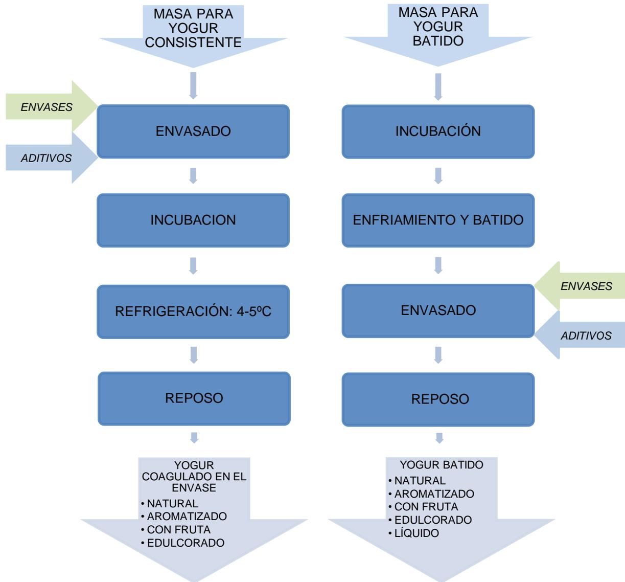
Ilustración 3.4 Diagrama de flujo para las operaciones de incubación y envasado
