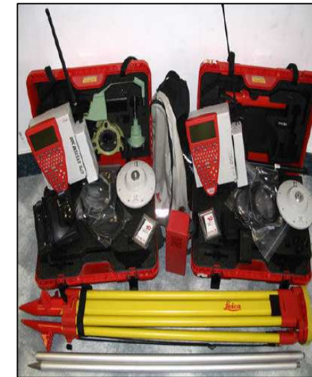
Fig.2.1: Imagen del equipo GPS Leica system 500 empleado para el trabajo del cálculo de la red en estático.
