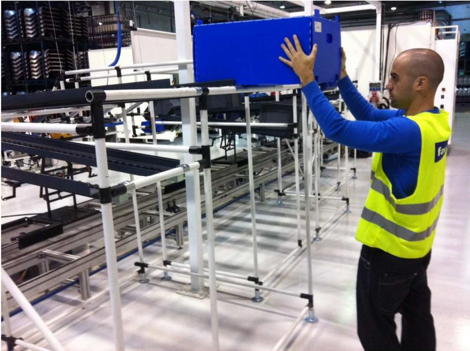
*Ilustración 10.1. Aprovisionamiento trasero a la línea de montaje.*
