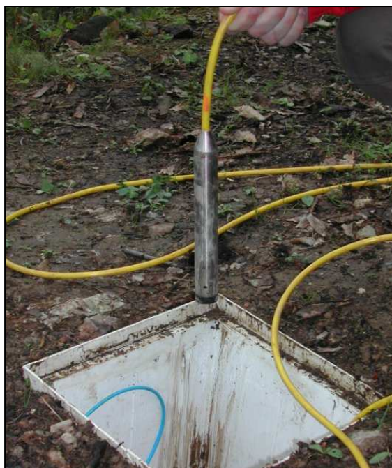
Figura 27. Fotografía de un piezómetro real antes de ser introducido en un sondeo.
