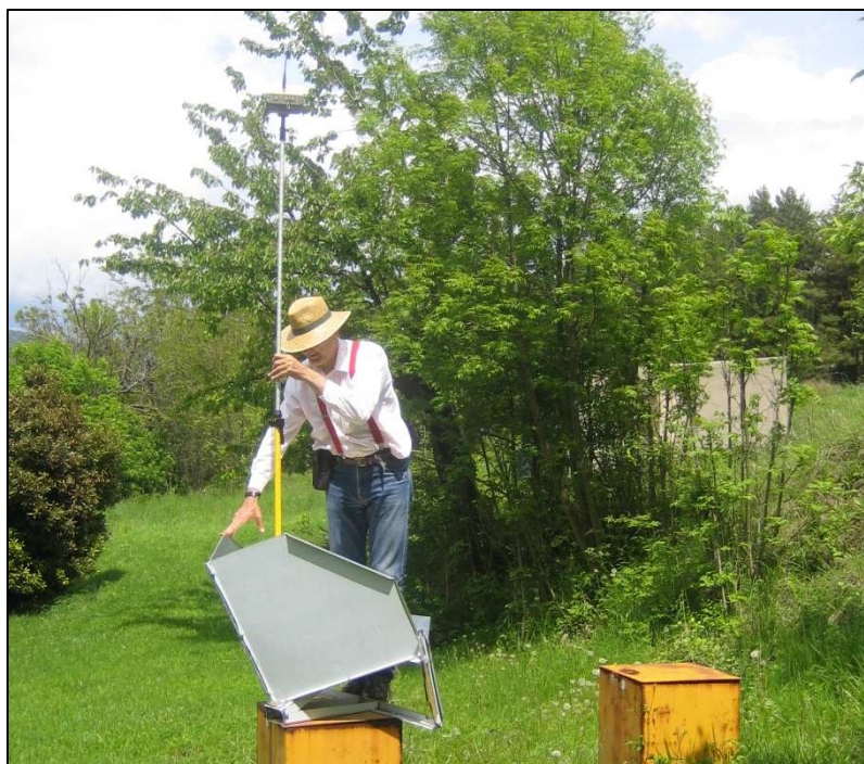
Figura 61. Fotografía de un receptor Rover tomando las coordenadas de un punto en Vallcebre en RTK (Campaña de medición de mayo de 2011).
