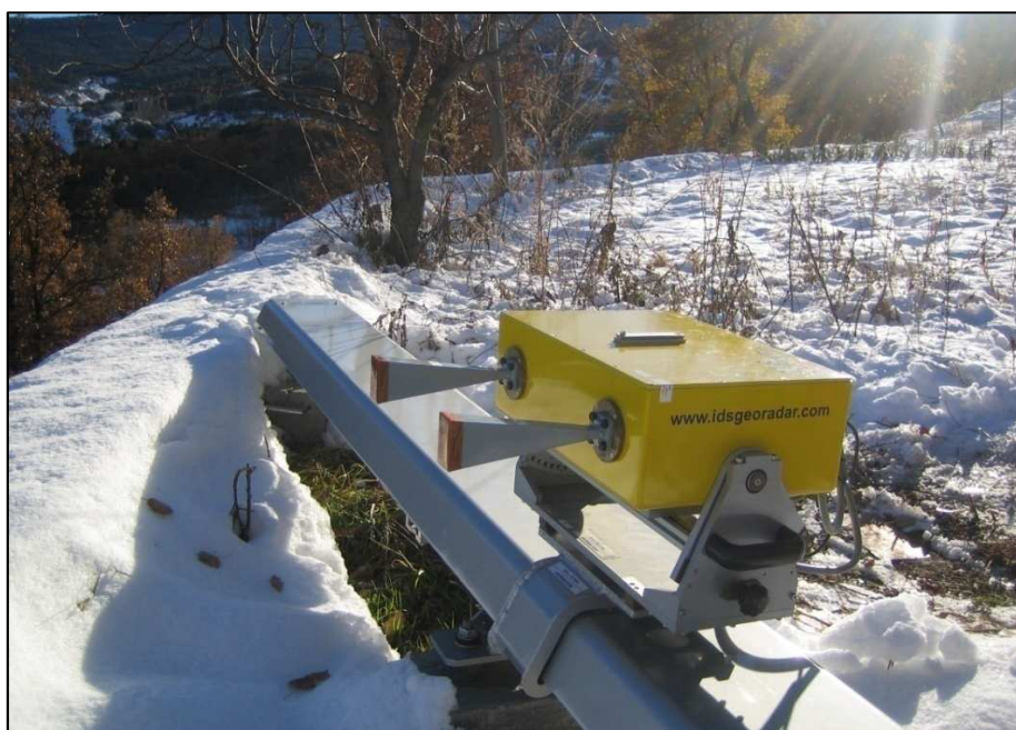
Figura 42. En esta fotografía se aprecia el sensor GB-SAR con sus dos antenas, emisora y receptora (izquierda y derecha respectivamente). Diciembre de 2010.
