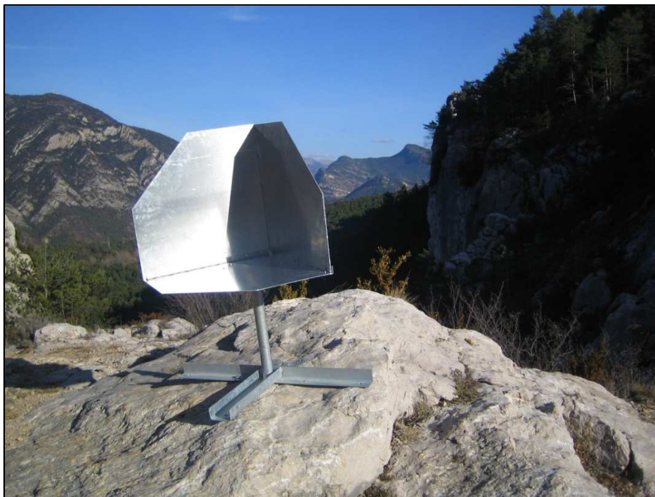
Figura 44. Corner reflector instalado en Vallcebre. Enero de 2011.
