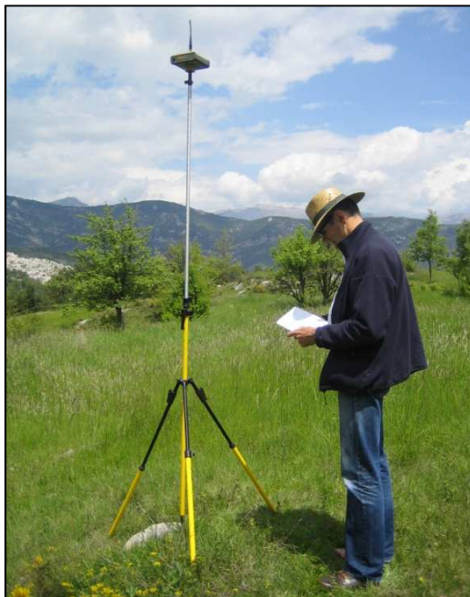
Figura 59. Fotografía de un receptor Rover tomando las coordenadas de un punto en Vallcebre en RTK (Campaña de medición de mayo de 2011).
