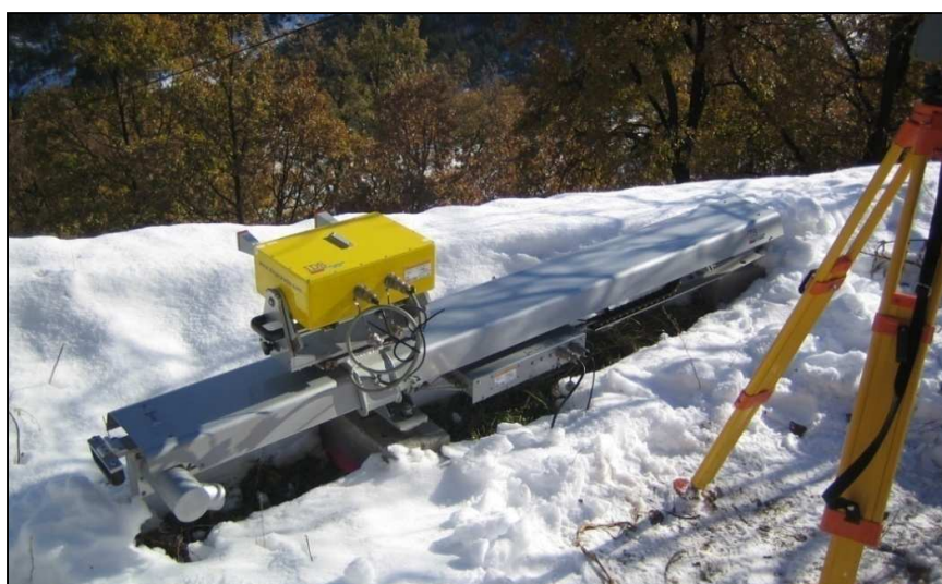
Figura 41. Sensor GB-SAR desplazándose a lo largo del rail en Vallcebre. Se puede apreciar el trípode de una estación total situada detrás del rail. Diciembre de 2010.
