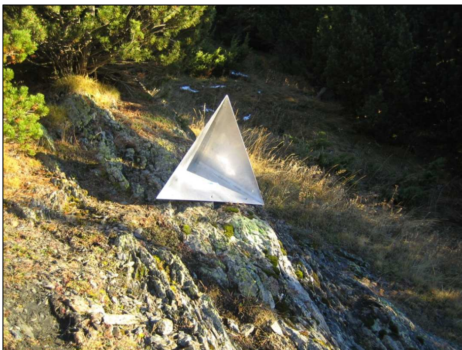
Figura 45. Corner reflector instalado en Canillo (Andorra). Noviembre de 2010.
