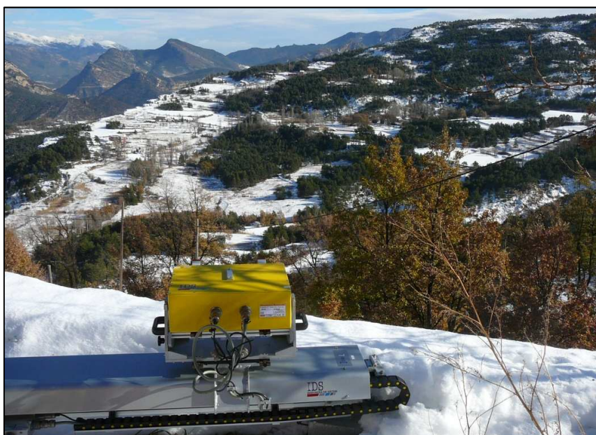
Figura 40. GB-SAR en funcionamiento instalado en Vallcebre, en la que se aprecia la ladera monitorizada. Diciembre de 2010.
