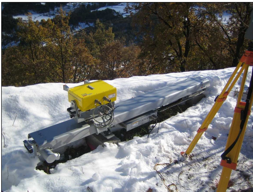
Figura 63. Fotografía en la que se aprecia la estación total situada tras el punto medio del raíl GB-SAR en funcionamiento. El punto estación debe materializarse adecuadamente sobre el terreno por tal que no se pierda o sufra movimientos indeseables.
