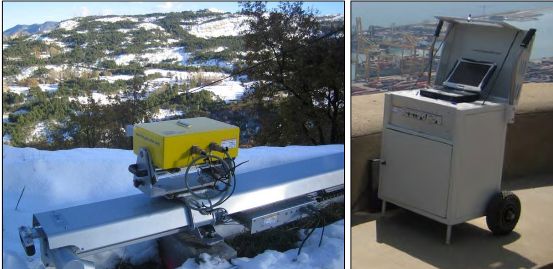
Figura 31. (a) Imagen real del sensor sobre el rail en Vallcebre. El sensor amarillo, montado sobre el rail, se desplaza de izquierda a derecha obteniendo múltiples perfiles radar para poder obtener una imagen SAR en cada pasada. (b) Unidad de control y de alimentación.
