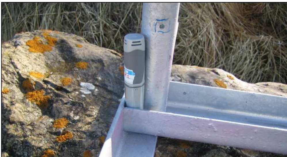
Figura 71. Sensor de temperatura y humedad situado en la base de un corner reflector de Vallcebre. Registra dichos valores cada 5 minutos.
