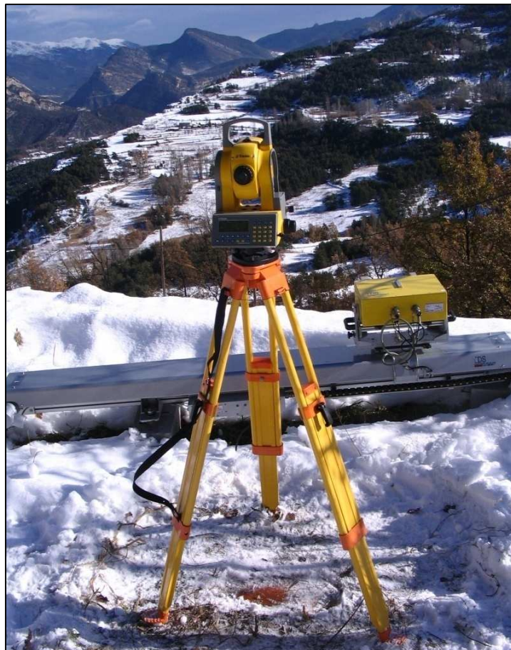
Figura 66. Fotografía en la que se aprecia la estación total situada tras el punto medio del raíl GB-SAR en funcionamiento.
