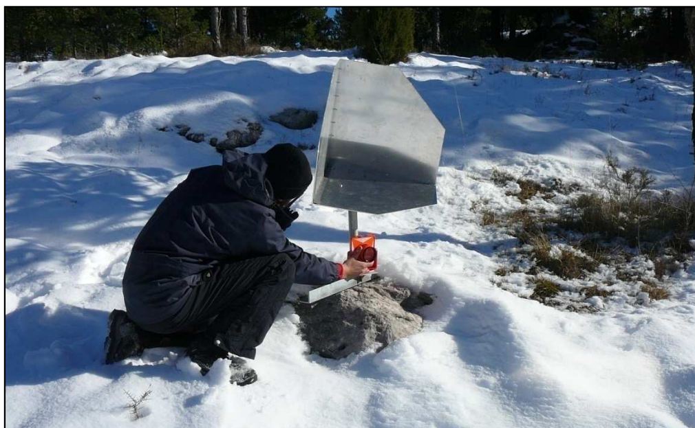
Figura 64. Prisma reflector sobre uno de los puntos inestables de la ladera, en este caso un punto marcado sobre el mástil de un corner reflector. La estación total está tomando medidas de ángulos y distancia en este momento.
