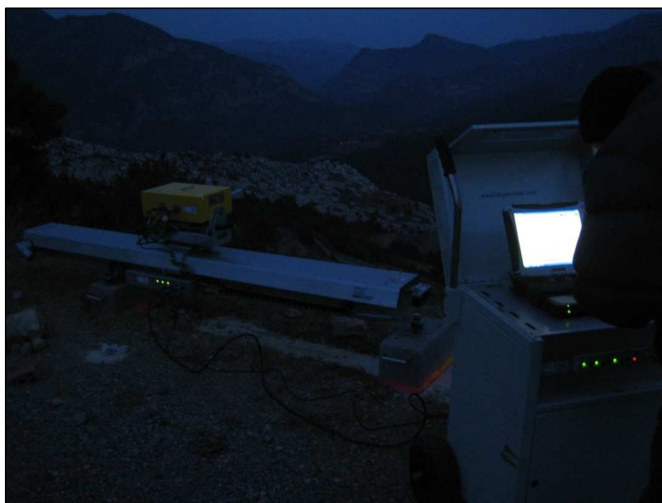
Figura 43. GB-SAR trabajando de noche en Vallcebre. Se aprecia el sensor desplazándose a lo largo del rail, la unidad de alimentación y la unidad de control. Enero de 2011.
