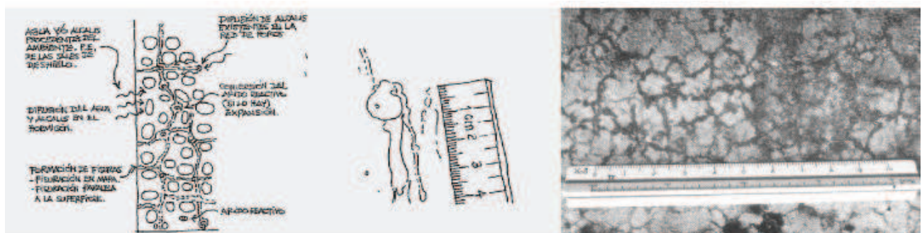
Fig. 50 - Croquis i exemple de les reaccions àcid-alcalí
