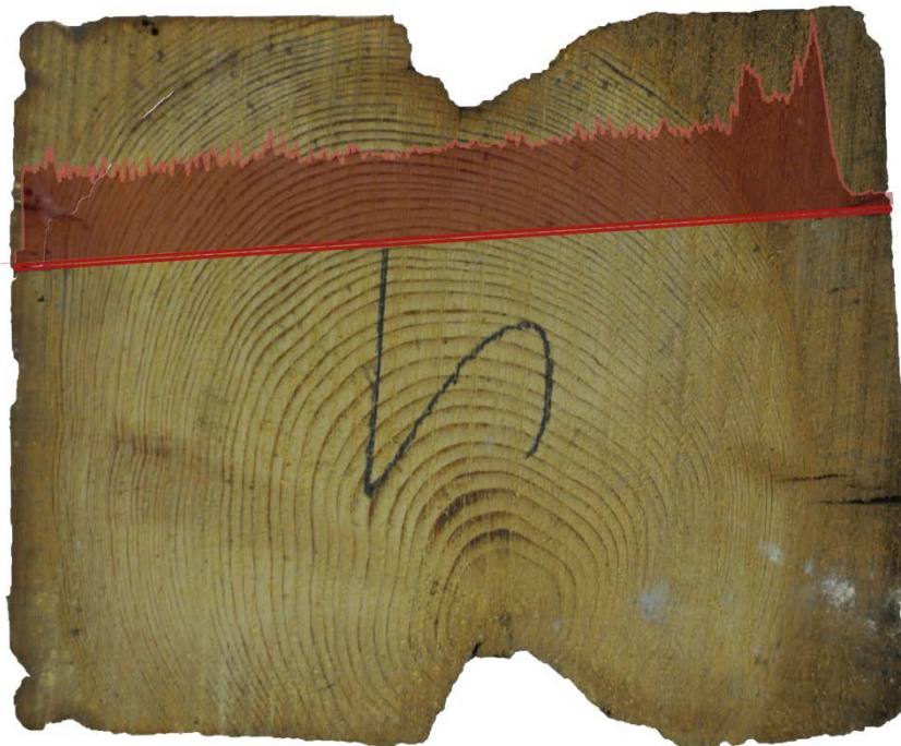
Il·lustració 38: Muntatge fotogràfic de la secció i gràfica del Resistògraf
