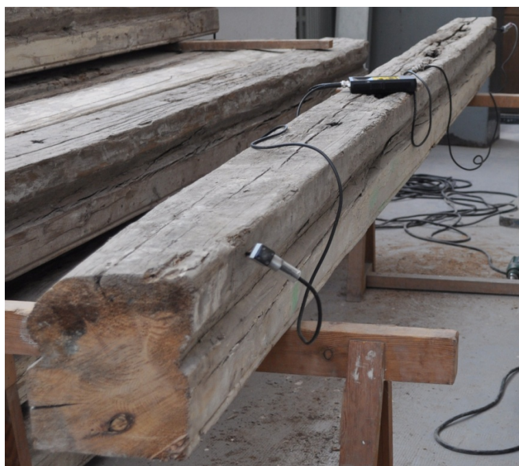
Il·lustració 58: Vistes generals de l'assaig des de diferents punts de vista. Lectura indirecta superior de la cara 2 de la biga
