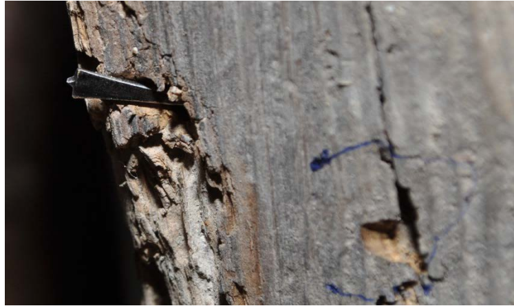
Il·lustració 39: Punta de la broca i forat de sortida
