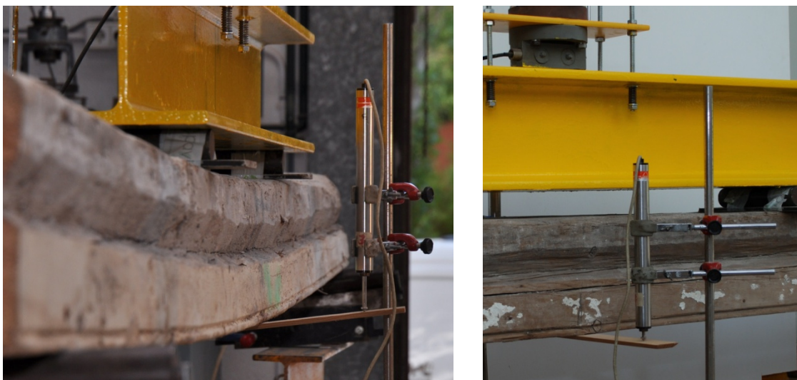
Il·lustració 78: Col·locació de l'extensòmetre pel càlcul de les deformacions en l'assaig global a flexió. La primera foto la càrrega està actuant i en la segona la biga està en repòs
