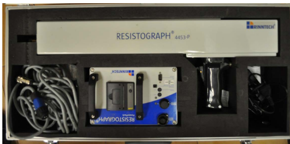
Il·lustració 34: RESISTOGRAPH® 4453-P, dins de la maleta de transport
