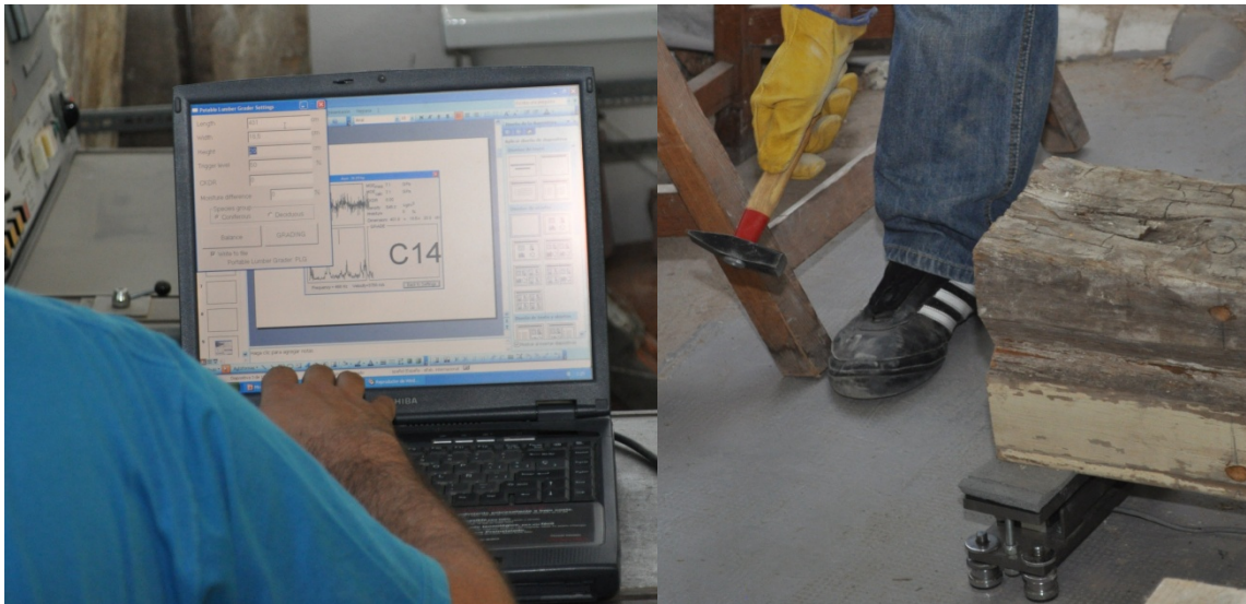
Il·lustració 63: Introducció de dades. Petit cop de martell a la testa de la biga
