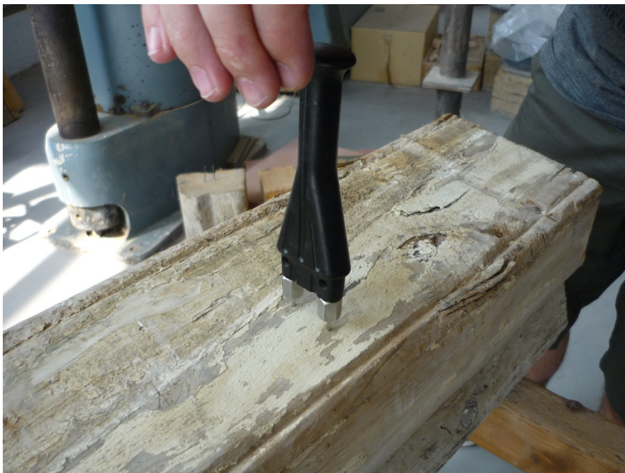
Il·lustració 44: Marcat de la separació de les puntes del xilohigròmetre
