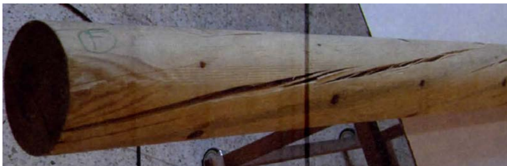
Il·lustració 14: Fibra revirada. Manual de clasificación de la madera
