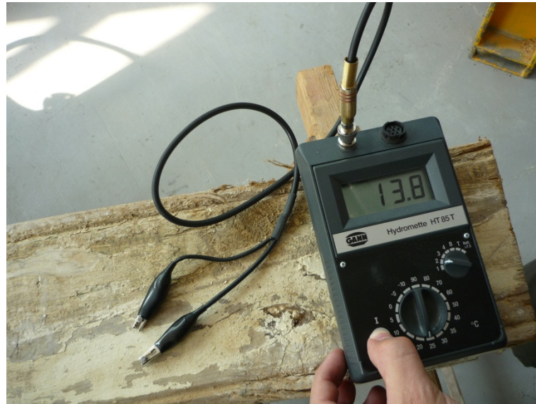
Il·lustració 45: Mesurament de la humitat de la fusta
