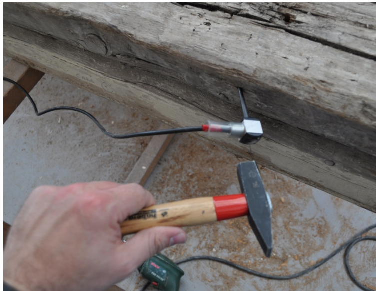
Il·lustració 57: Transductor emissor sent copejat pel martell i així genera l'ona d'impacte
