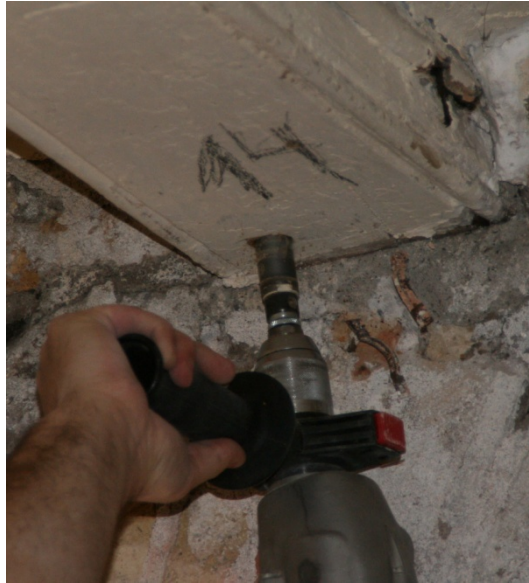
Il·lustració 5: Extracció in situ de microprovetes cilíndriques
