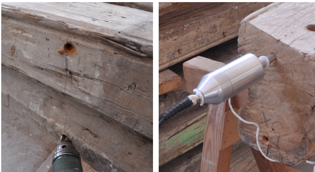
Il·lustració 53: Realització dels forats i col·locació dels palpadors
