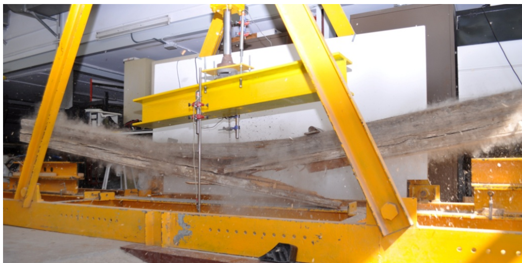
Il·lustració 79 : Biga sotmesa a una càrrega a punt d'arribar al moment de la ruptura a flexió. Moment on es produeix la ruptura de la biga
