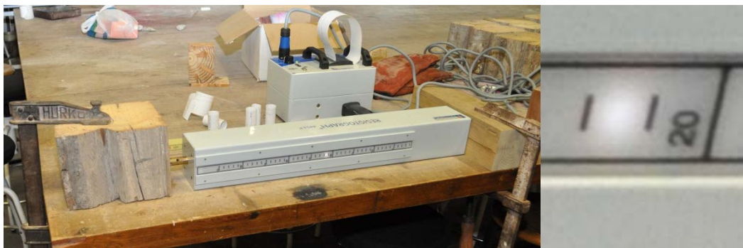
Il·lustració 35: Realització del assaig del Resistògraf
