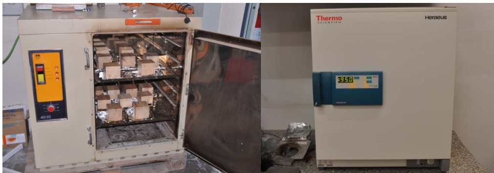
Il·lustració 40: Estufes d'assecat amb circulació lliure d'aire en l'interior
