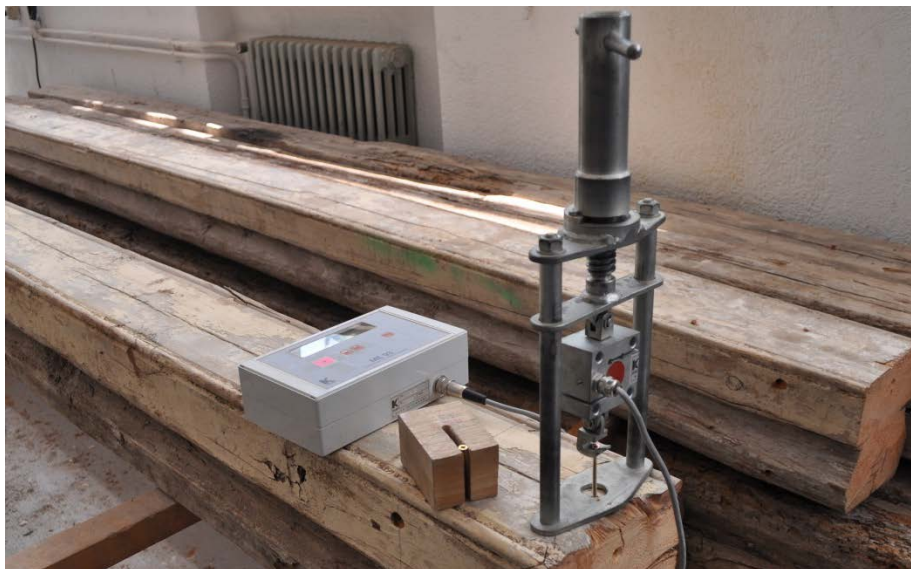
Il·lustració 31: Màquina d'arrencament de vis, galga de profunditat i unitat de control
