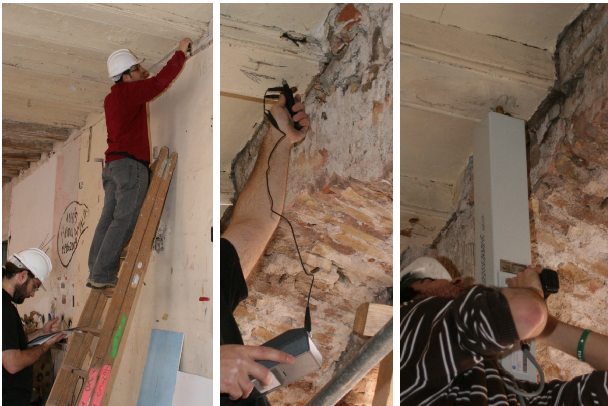
Il·lustració 4: Registre de la geometria de les bigues. Humitats de les bigues. Assaig amb el Resistògraf
