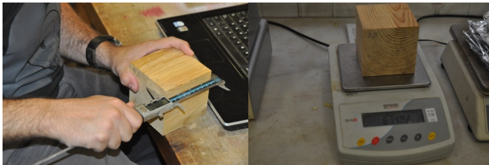
Il·lustració 25: Mesurat i pesat de les provetes
