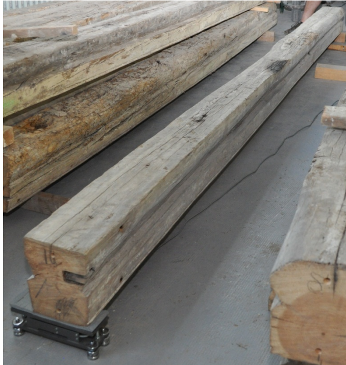
Il·lustració 64: Vista general de l'assaig de vibració longitudinal
