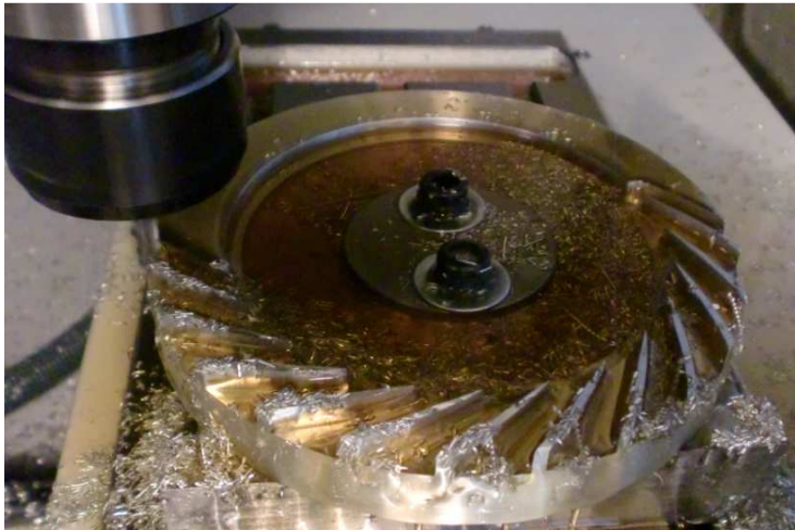
Fotografía 12. Mecanizado CNC del difusor. Se puede ver el aceite refrigerante utilizado para poder utilizar mayores velocidades de corte.
