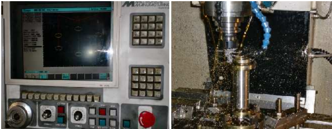
Fotografía 17. Simulación en la fresadora del programa y posterior mecanizado.
