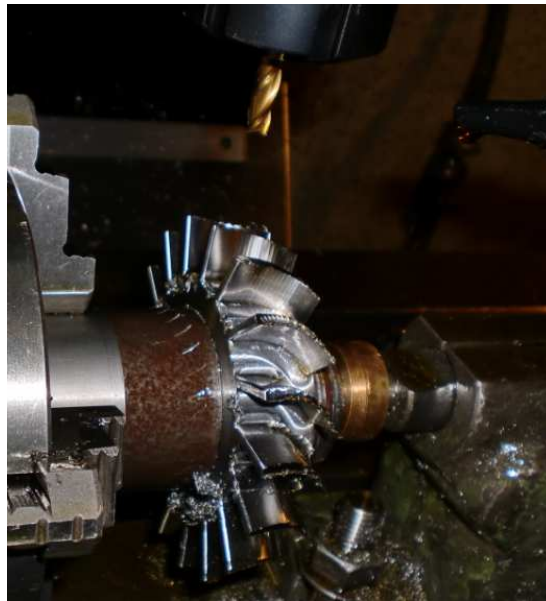
Fotografía 23. Mecanizado del cuerpo de toberas en la fresa CNC.
