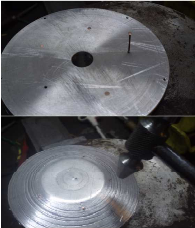
Fotografía 9. Remachado manual del compresor
