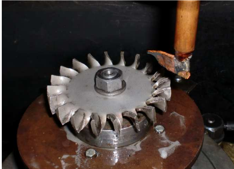
Fotografía 26. Rueda de la turbina puesta en la máquina de electroerosión. Se observa el ánodo de cobre utilizado para electroerosionar el acero inoxidable.
