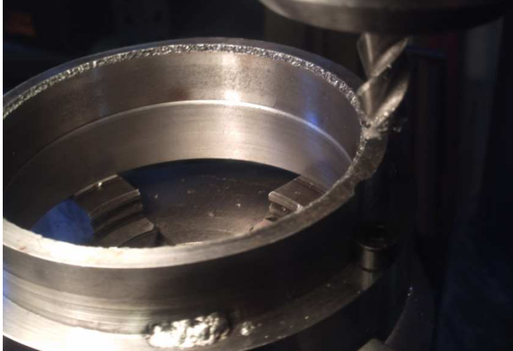
Fotografía 31. Carcasa del estator. Se puede ver la unión soldada.
