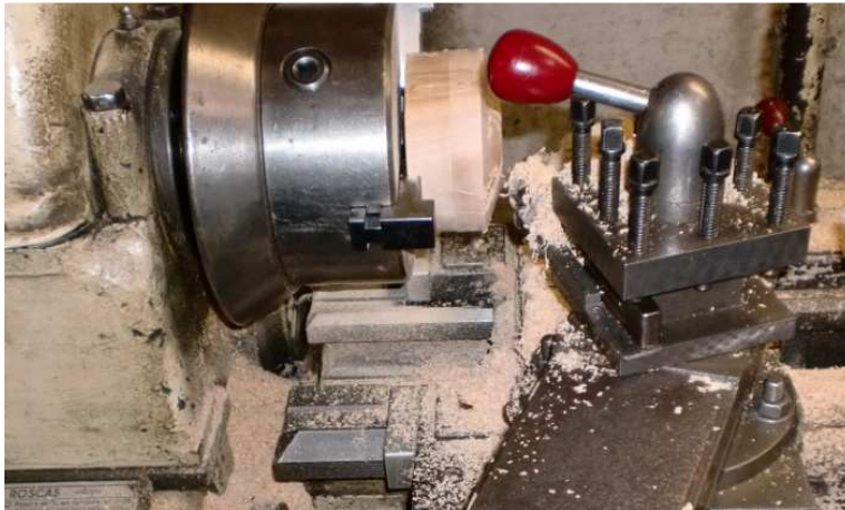
Fotografía 3. Fabricación del molde macho
