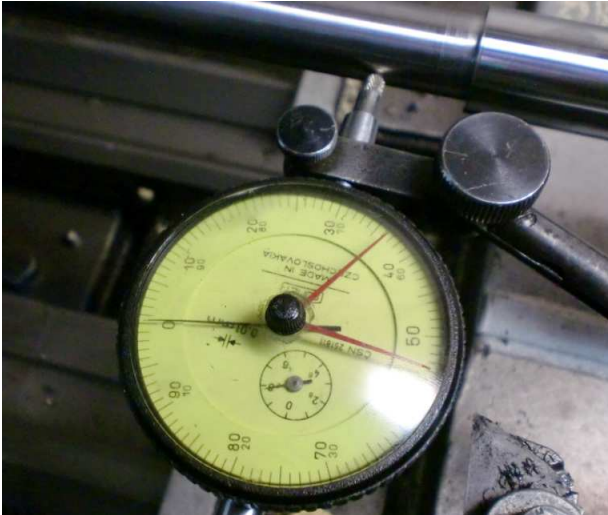
Fotografía 20. Comprobación del buen centrado del eje mediante comparador. Tolerancia 0,01mm.
