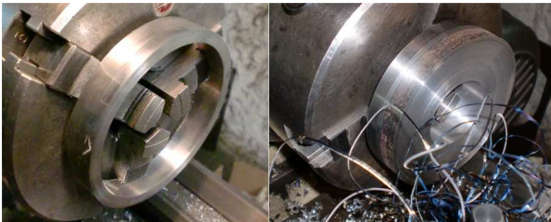
Fotografía 30. Torneado de los dos cilindros para la carcasa de la turbina.
