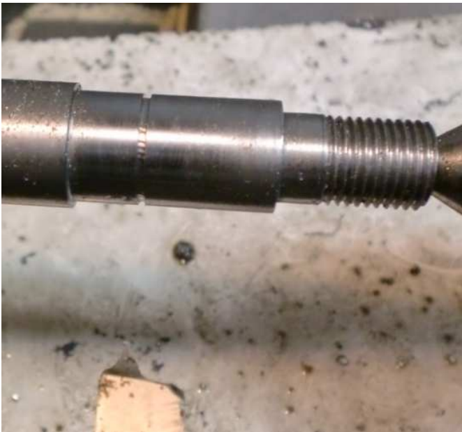
Fotografía 21. Detalle de la rosca y asiento para la arandela sieger.
