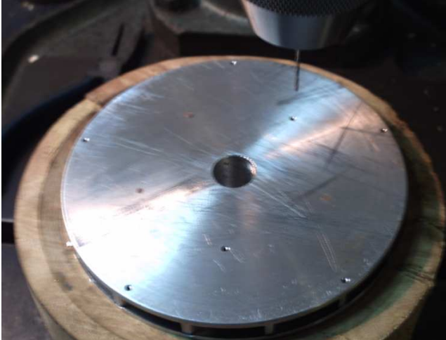
Fotografía 7. Taladrado de la chapa embutida. El taladro pasa esta vez por los agujeros ya hechos y solo perfora la chapa que hay debajo.
