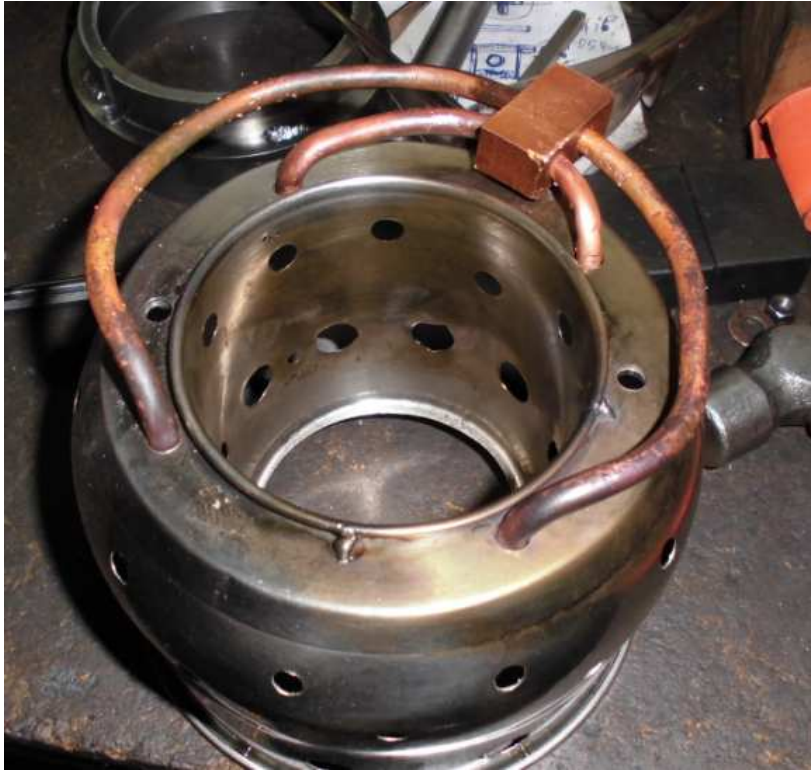
Fotografía 35. Tubos de llama de la cámara de combustión finalizados.
