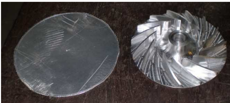
Fotografía 2. Rodete del TC mecanizado y chapa para taparlo
