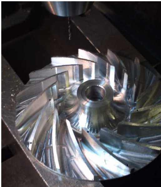
Fotografía 6. Taladrado de los agujeros para el remachado. Se observa los puntos de entrada para el taladro realizados con la máquina de electroerosión
