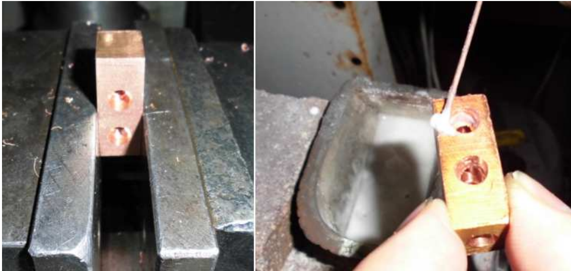
Fotografía 34. Preparación para la soldadura a la plata.
