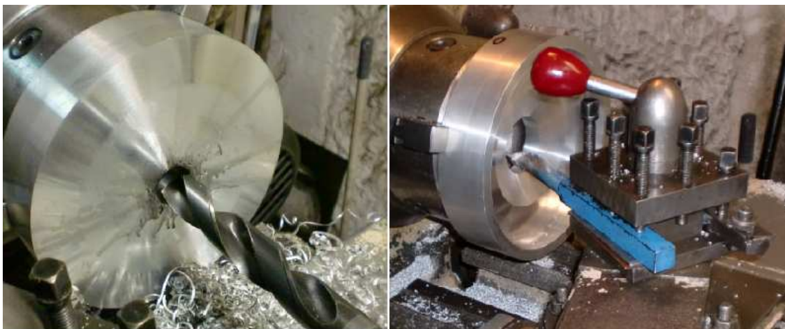
Fotografía 13. Mecanizado de la tapa del difusor. En la segunda imagen, se está utilizando una herramienta de interiores.
