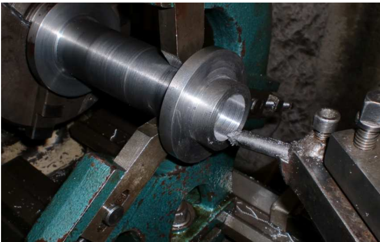
Fotografía 15. Torneado de los asientos del cojinete. Se puede observar el montaje con lunetas debido a la gran longitud de la pieza.
