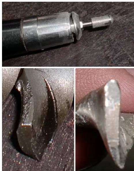
Fotografía 27. Muela manual de altas revoluciones. Se observa el cambio en la superficie del álabe antes.
