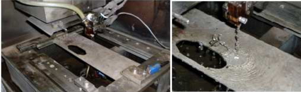
Fotografía 24. Corte de la chapa en la máquina CNC de hilo.
