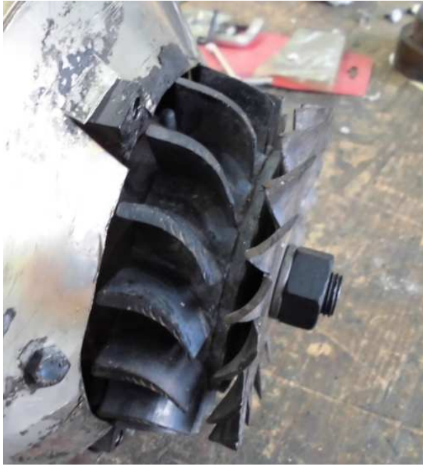
Fotografía 29. Toberas y toberopaletas. Se pueden observar los triángulos de velocidades calculados
