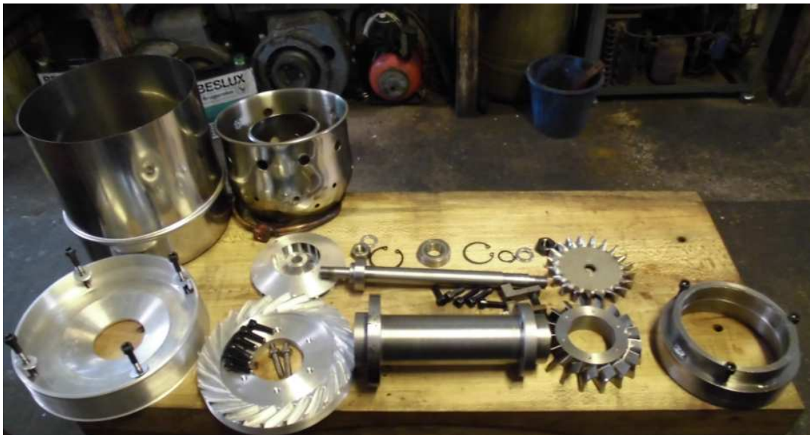
Fotografía 37. Vista del despiece de la turbina.
