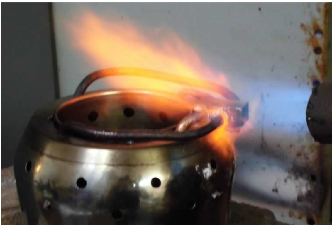
Fotografía 35. Soldado del distribuidor a los tubos de llama.
