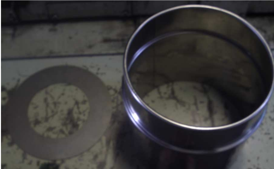
Fotografía 36. Tubo de la cámara de combustión y anillo para cerrarla.
