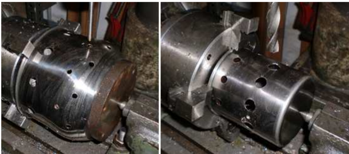
Fotografía 33. Agujereado de los tubos de llama.
