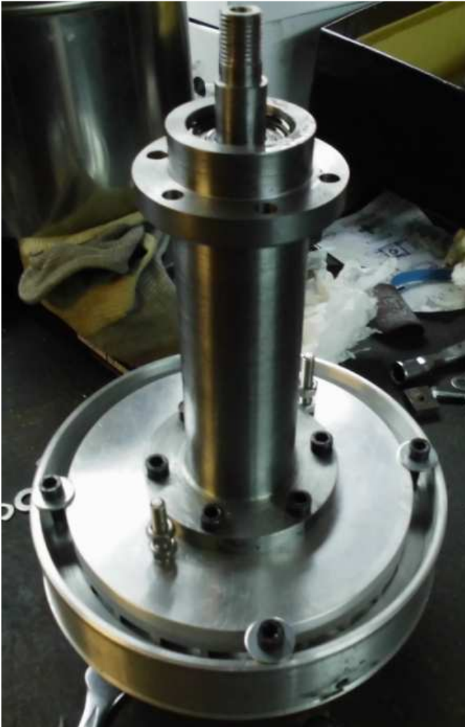
Fotografía 38. Montaje del eje, estructura interna y compresor.
