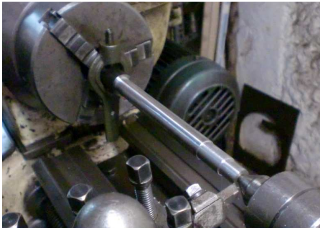
Fotografía 19. Torneado del eje. Se puede ver el perro de arrastre al final del eje.
