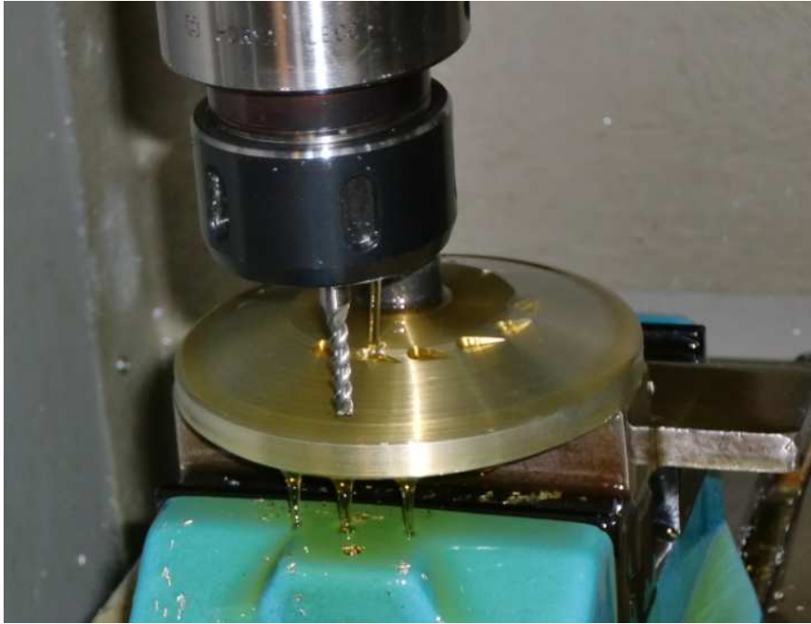
Fotografía 1. Se observa la forma primitiva del troncocono realizado con el torno y puesto en la máquina de CNC con el refrigerante.
