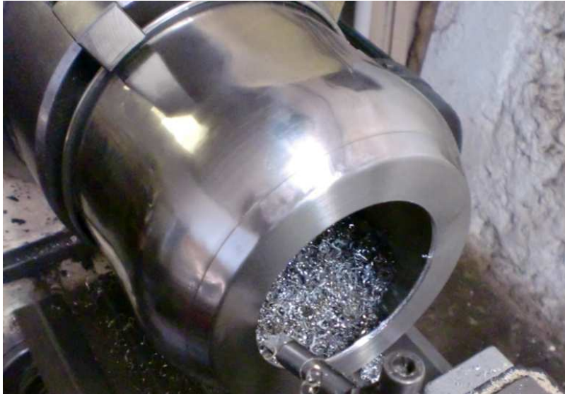
Fotografía 32. Corte del tubo de llama exterior.
