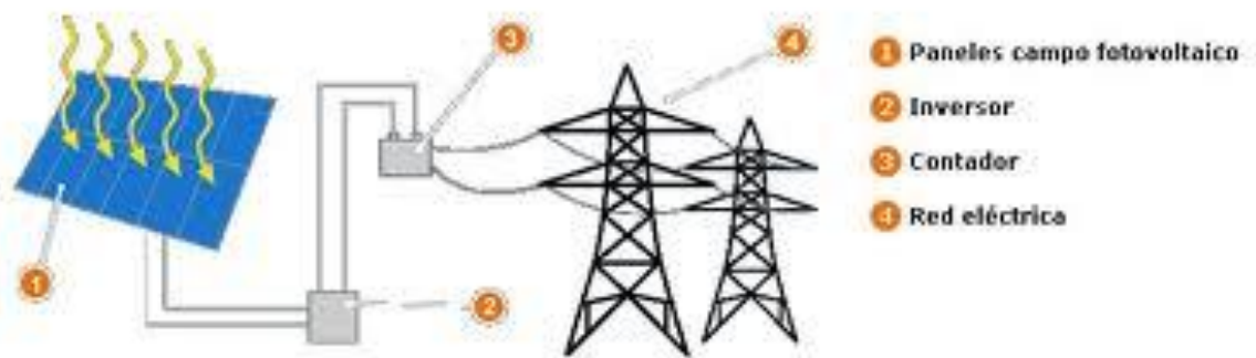
Fig.1.1. Esquema del proceso de transformación de la energía fotovoltaica a la red eléctrica
