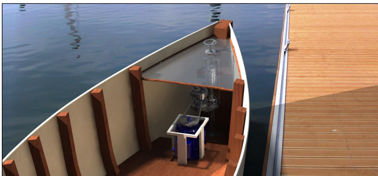
FIGURA 2.95. Destall de la vista superior del SPM instal·lat al llagut
