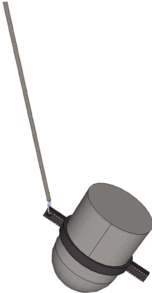
FIGURA 5.24: ASSEMBLATGE DEL GRILLÓ AMB L'ESTRUCTURA I EL CABLE DE CONTROL
