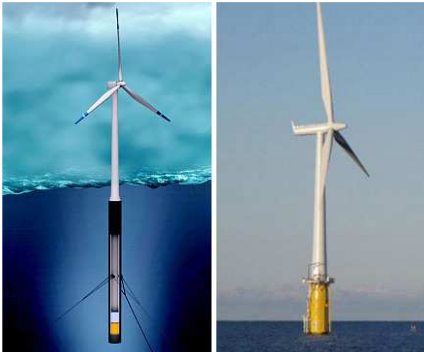
FIGURA 2.2: ESQUEMA DE MOLÍ FLOTANT TIPUS SPAR I FOTOGRAFIA DEL HYWIND. FONT: ECOVIVE.COM [6]
