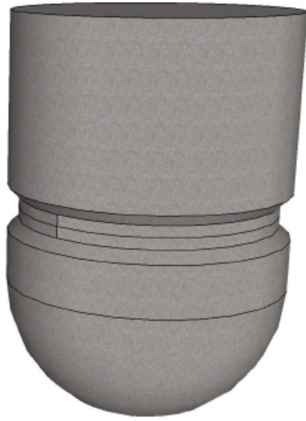
FIGURA 5.23 DETALL DE LA INCISIÓ AL FLOTADOR DE L'ESTRUCTURA
