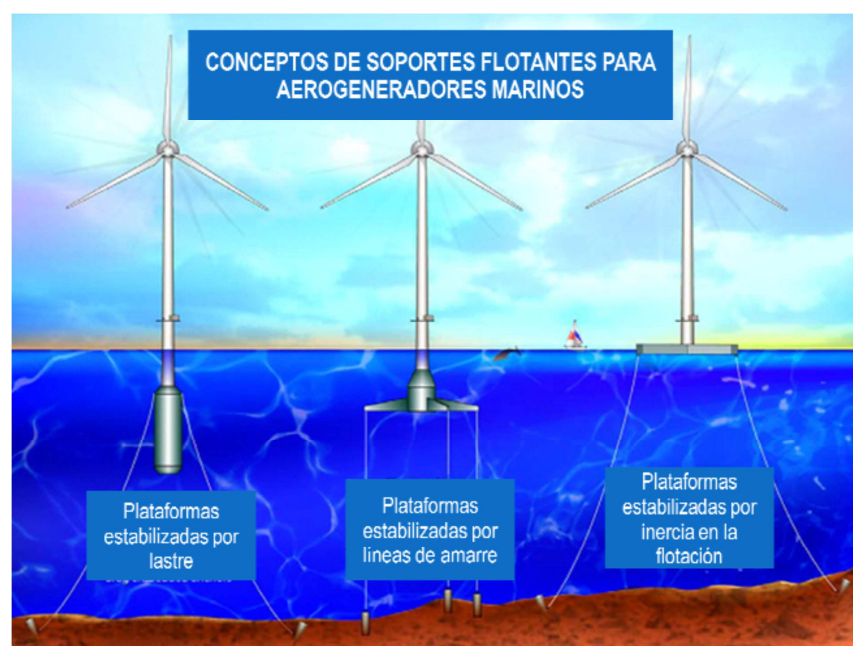
FIGURA 2.1: TIPOLOGIES D'AEROGENERADORS FLOTANTS. FONT: NREL [5]
