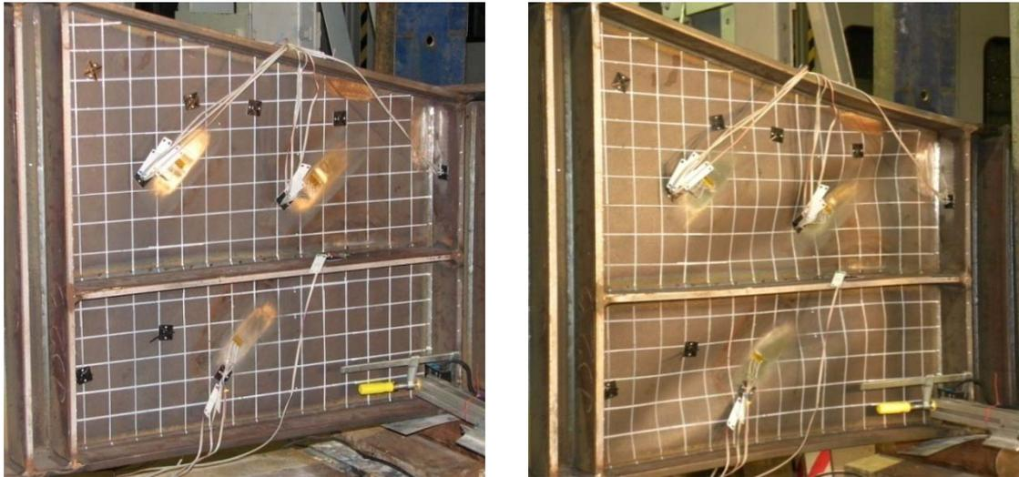
Figura 4.23: Comparación deformada de la viga A1 antes y después de la abolladura.
