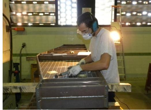
Figura 4.16: Izq. Situación previa de una galga. Dcha. Proceso de lijado.
