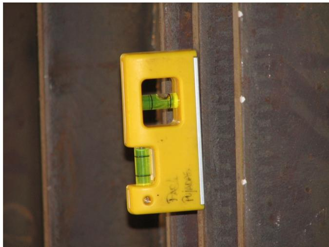
**Figura 4.26: Inclinación del rigidizador vertical central del espécimen B2.**
