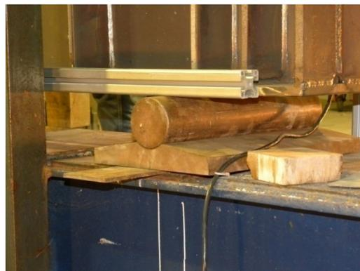
Figura 4.8: Tipo de apoyo utilizado en los ensayos.
