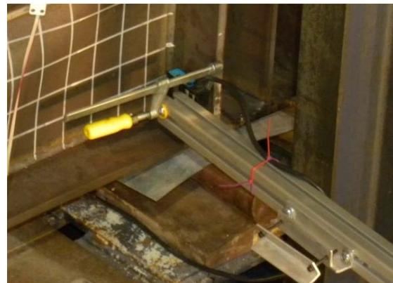
Figura 4.5: Izq. Transductores de desplazamiento en el alma (temposónicos). Dcha. láser en los apoyos.
