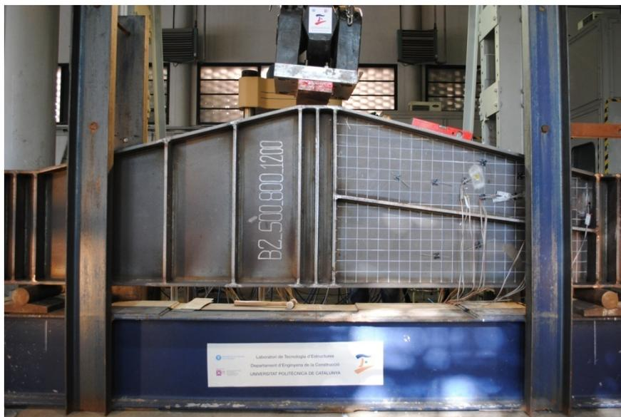
Figura 4.6: En horizontal, la viga cargadera y los UPN en vertical.
