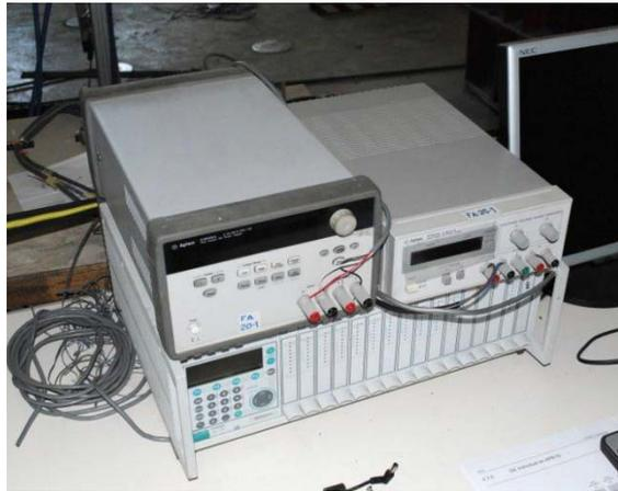
Figura 4.10: Izq. aparato de conexión de las galgas. Dcha. módulo de recepción de datos.
