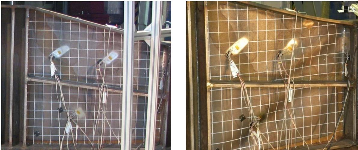
Figura 4.21: Comparación deformada de la viga A2 antes y después de la abolladura.
