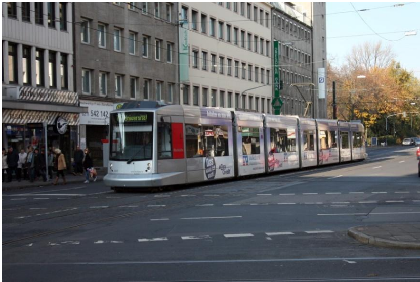
Figura 11. Tranvía en vía compartida con el tráfico rodado en Düsseldorf (Alemania). Fuente: [7]
