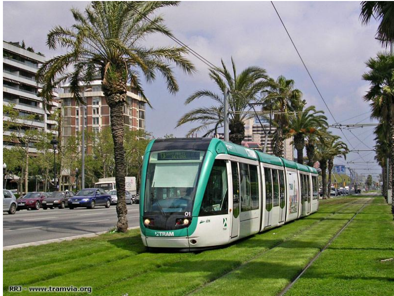
Figura 9. Tranvía de Barcelona (línea TramBaix) en un tramo de la Diagonal en vía completamente segregada. Fuente: [6]
