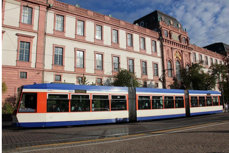
Figura 12. Tranvía de Darmstadt (Alemania) equipado con 3 módulos. Fuente: [7]
