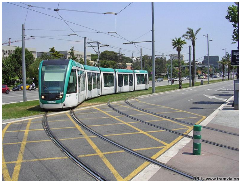
Figura 10. Tranvía de Barcelona (línea TramBaix) en un tramo de la Av. Diagonal dónde comparte espacio con el tráfico motorizado. Fuente: [6]
