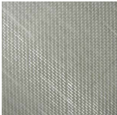
Img 40. Fibra de Vidrio biaxial con puntada. Fuente http://www.chinafrp.es/6-3-glass-fiber-fabrics.html
