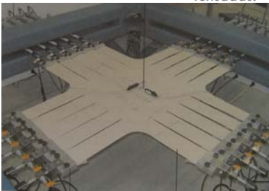
Fig.43 Comportamiento de la propagación del desgarro de una membrana con pretensado biaxial. Fuente Europea de diseño de las estructuras Superficiales tensadas.
