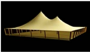
Img.14 Membrana sin pretensado. Fuente issuu.com
