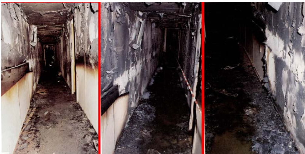
· Foto 21: pasillo de estribor de la cubierta 3 donde se inició el segundo y principal incendio a popa de la escalera 2 Er, en la imagen izquierda se aprecia la puerta abierta del camarote 219.
