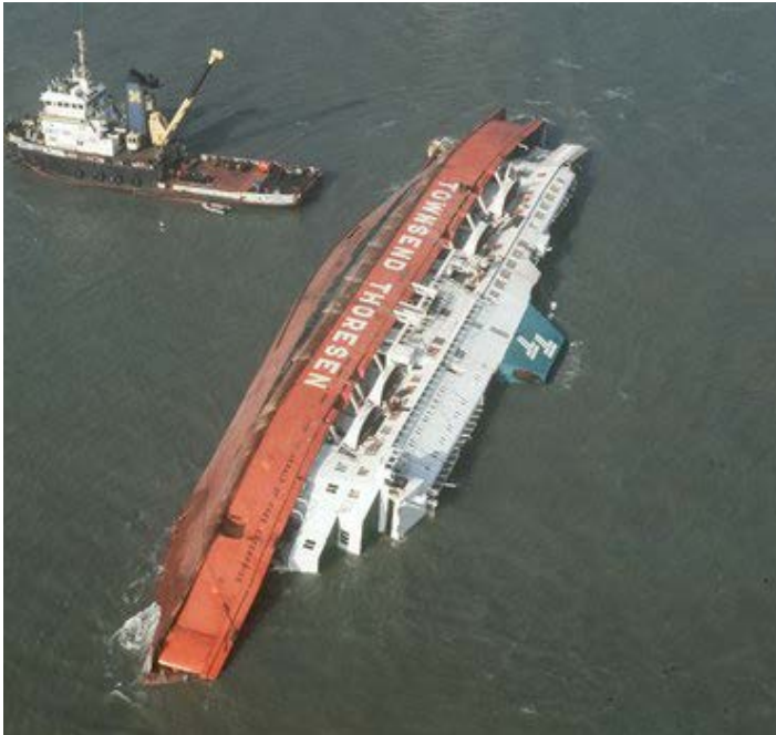
· Foto 15: posición de equilibrio en la que permaneció el Ferry después de la gran escora.
