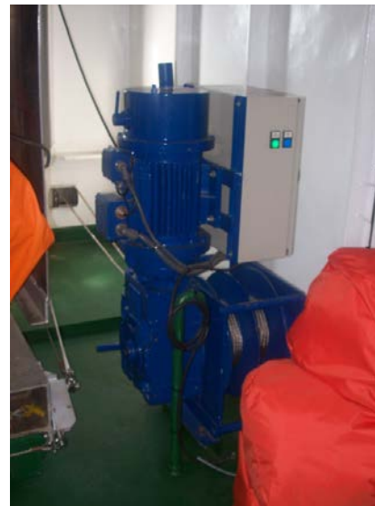
· Foto 36: cabestrante eléctrico que mantiene las balsas infladas junto al costado del barco.
