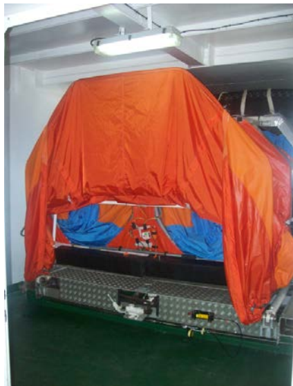
· Foto 35: sistema M.E.S. Popa Babor plegado en su local de lanzamiento.
