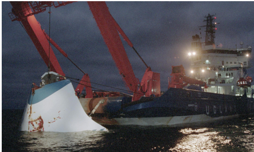
· Foto 28: recuperación de la visera desprendida de la proa del Estonia.
