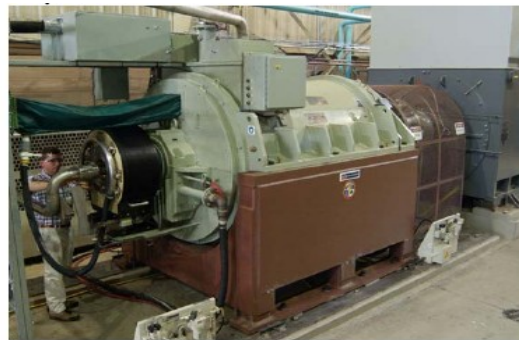
Figura 108 – Motor HTS de 36.5 MW (izquierda) y comparación visual entre un motor de cobre de 21 MW y 183 Tm de peso y un motor HTS de 36.5 MW y 75 Tm de peso (derecha), motor HTS de 5 MW (debajo) (Fuente: AMSC (imágenes superiores); Kalsi)
