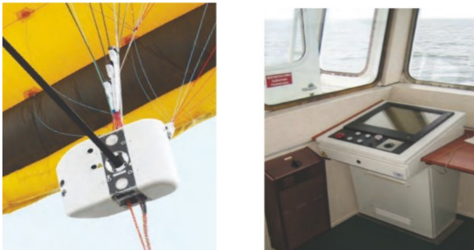
Figura 82 – Controlador de la cometa tractora (izquierda) y dispositivo de control integrado en el puente (derecha) (Fuente: Skysail)
