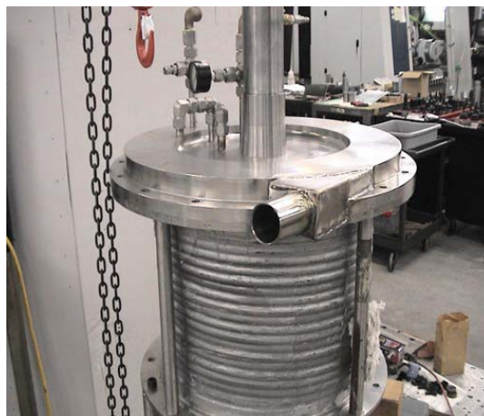
Figura 61 – Intercambiador recuperador vorticial de calor (Fuente: Bourne et al, 2001)
