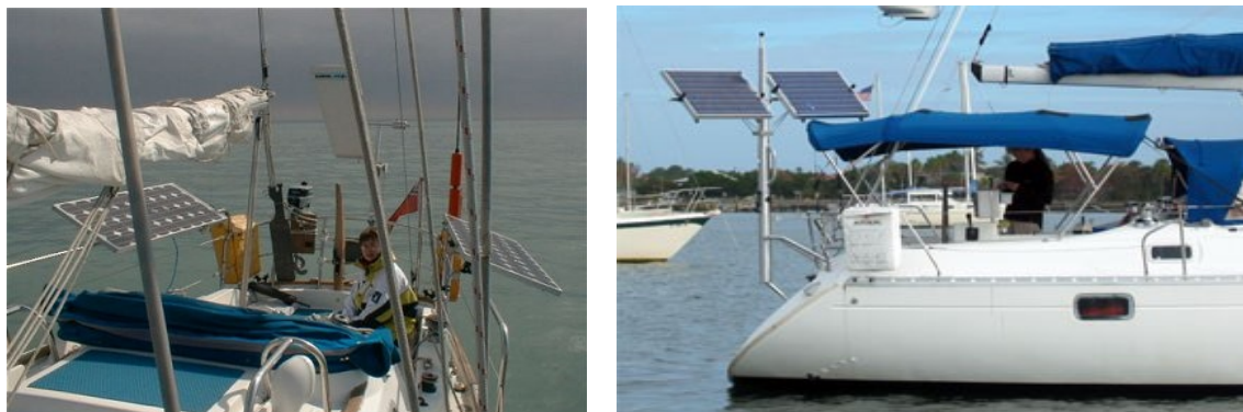
Figura 73 – Instalaciones de paneles fotovoltaicos en veleros (Fuente: Wikipedia, Sailmiami)
