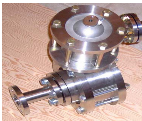
Figura 62 – Cámara de combustión vorticial (Fuente: Bourne et al, 2001)
