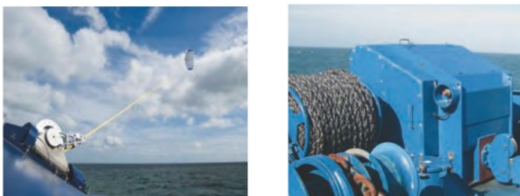
Figura 80 – Cabo y punto de remolque (izquierda) y compartimento (exterior) del cabrestante (Fuente: Skysail)
