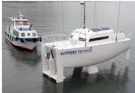
Figura 99 – Suntory Mermaid II (arriba), movimiento de las aletas siguiendo el perfil de las olas (Fuente: Inhabitat; Tokio University, School of Marine Science and Technology )
