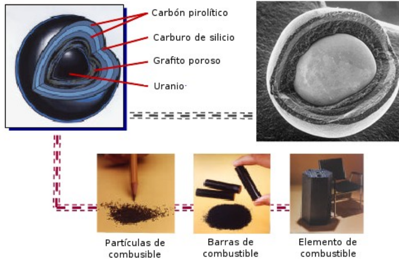
Figura 23 – Combustible TRISO (Fuente: General Atomics, US Department of energy, imágenes modificadas y adaptadas por el autor)
