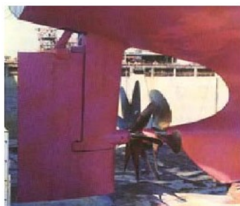
Figura 125 – Hélice de paletas de Grim (Fuente: Marineblogspot)
