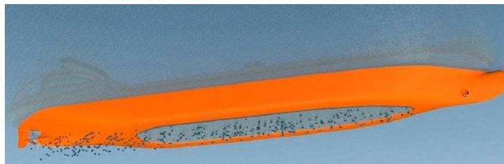
Figura 134 – Diseño conceptual de un buque lubricado con aire (Fuente: Wärtsilä, 2009)
