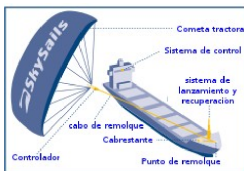
Figura 79 – Componentes del dispositivo (Fuente: Skysail; imagen adaptada por el autor)
