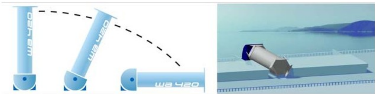
Figura 92 – Diagrama de un rotor Flettner plegable (Fuente: Windagain)
