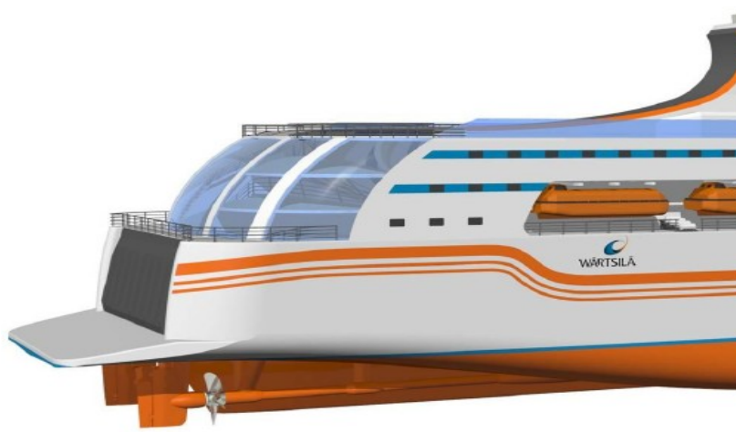
Figura 139 – Diseño conceptual de un dispositivo de extensión de la línea de flotación cola de pato instalada en un crucero (Fuente: Wärtsilä, 2009)
