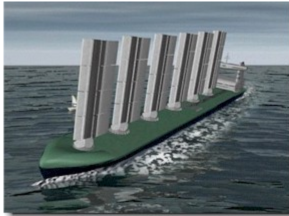
Figura 98 – Diseño conceptual del buque bulkcarrier de 50000 TM de peso muerto del proyecto Modern Windship (Fuente: Marinetalk )
