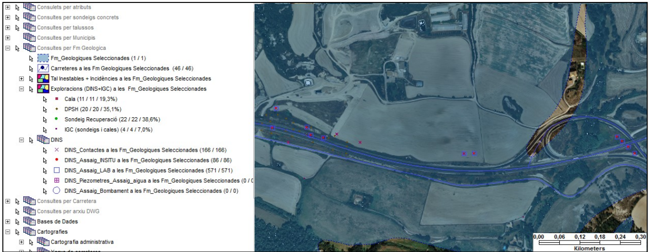
Fig. 112: Detall d’exploracions de la BD DINS de GISA trobades a la formació geològica seleccionada, representades en funció dels assaigs que s’han realitzat a cada exploració.
