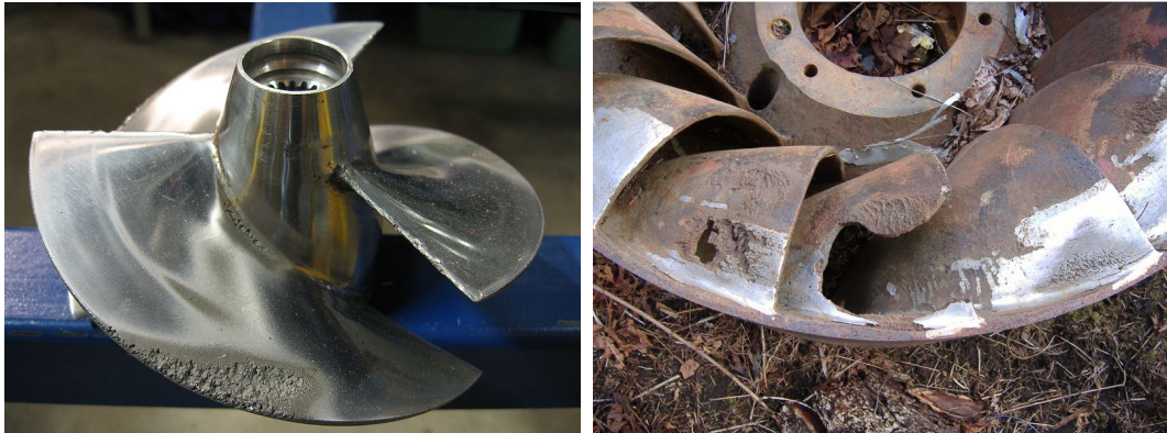
Figura 8. A la izquierda, hélice dañada por el fenómeno de la cavitación. A la derecha, daño por cavitación de una turbina Francis. Fotos extraídas de http://www.originalpropshop.com.au/ y http://upload.wikimedia.org/wikipedia/commons/thumb
