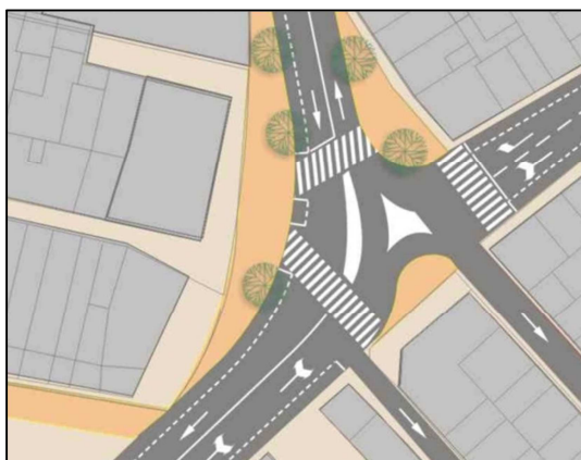
Figura 3.28. Mejora de la movilidad peatonal en la plaza del Ayuntamiento de Tremp. [Fuente: Plan de Movilidad Urbana de Tremp]
