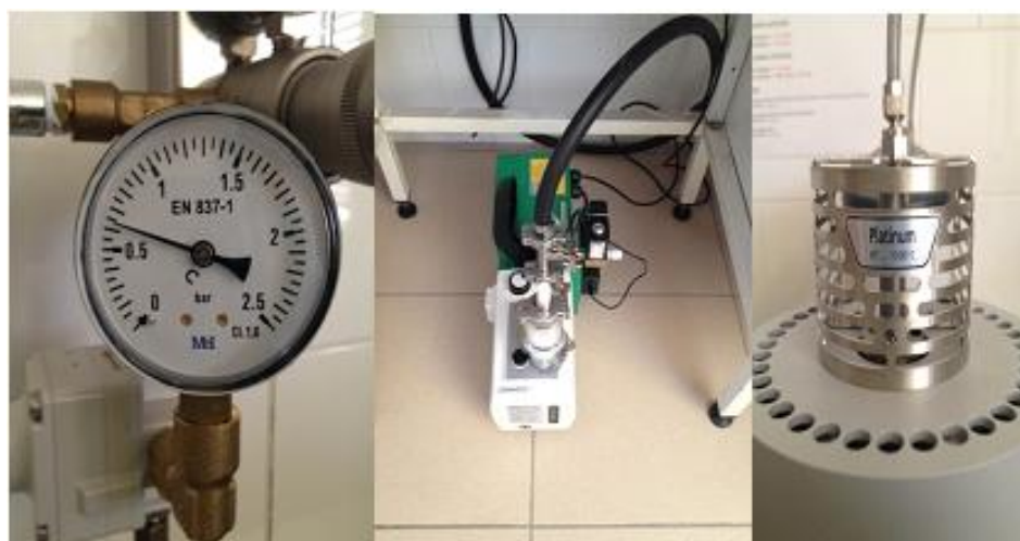
Figura 3.3. Manómetro por encima de 0.5 bar, bomba de vacío, y horno Platinum (RT... 1500° C). Imágenes tomadas en el laboratorio.
