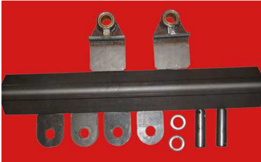
Figura 3.4 Elementos que forman el punto de vuelco
