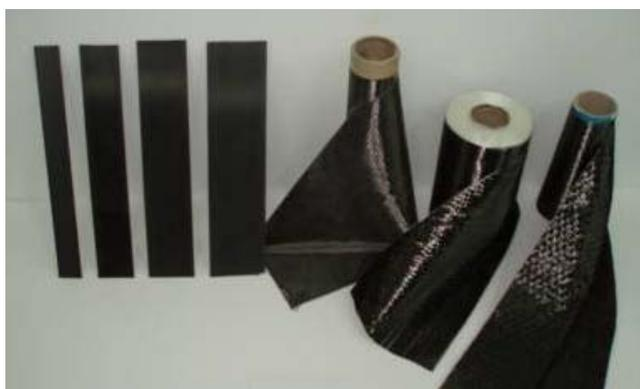
Fig. 18. Material compuesto FRP
