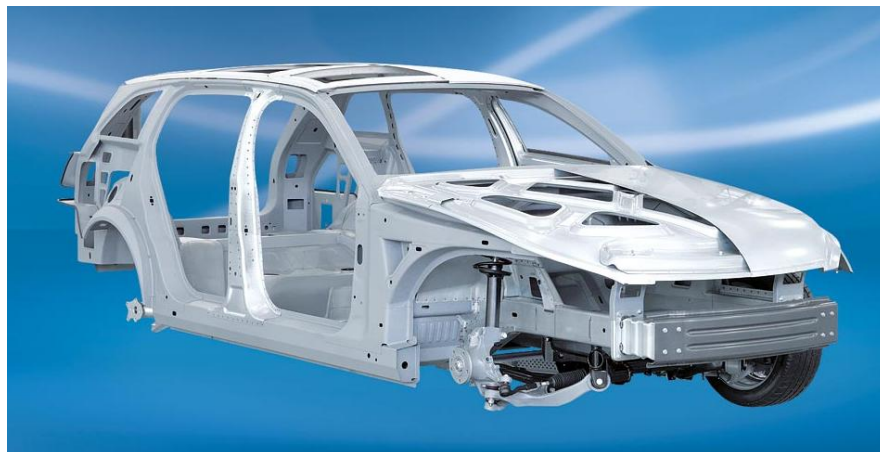
FIGURA 5: Carrosseria autoportant d'un vehicle
