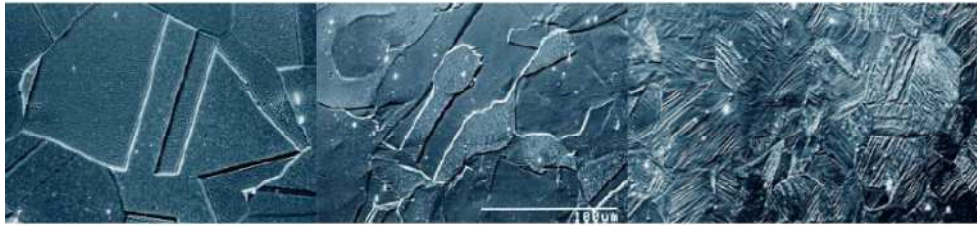
FIGURA 18 : Mostres d'acer TWIP a diferents graus de deformació (0,5 % i 78 %)
