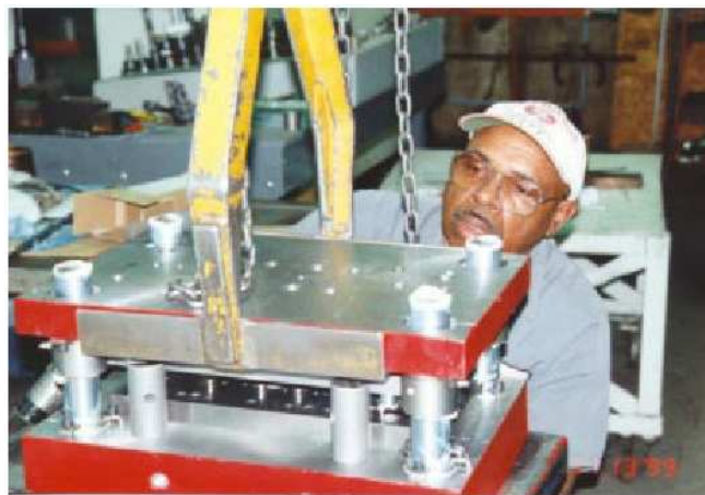
FIGURA 87 : Manteniment d'una matriu després de la producció
