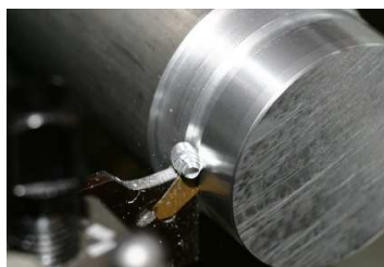
FIGURA 41 : Fabricació per arrencament de ferritja
