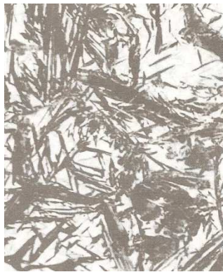
FIGURA 28 : Fotomicrografia d'un acer amb microestructura martensítica
