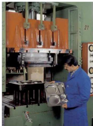
FIGURA 90 : Comprovació de les peces després del manteniment de la matriu
