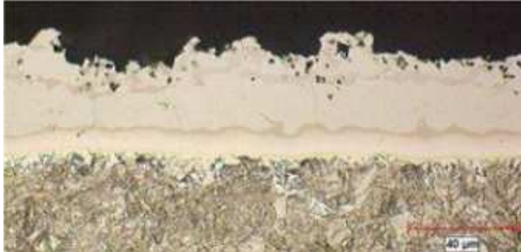
FIGURA 20 : Aspecte del recobriment després de l'estampació en calent
