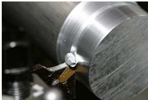
FIGURA 36: Fabricació per arrancament de ferritxa
