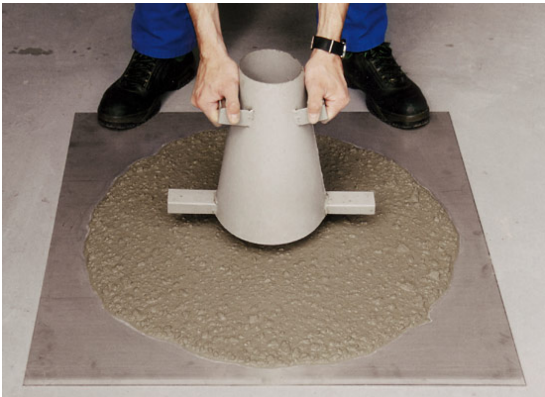
Figura 2.1 - Assaig de flux d'assentament amb con d'Abrams per a formigó autocompactable (Rhein Chemotechnik)
