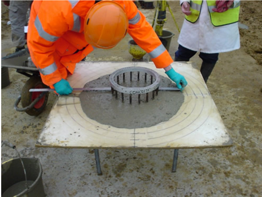
Figura 2.2 - Assaig de capacitat de pas, conegut com anell J, per a formigó autocompactable (Cement Admixtures Association)
