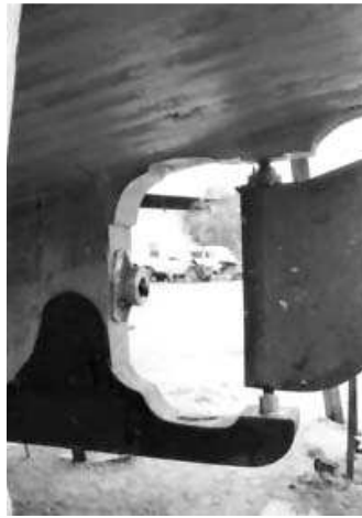
Figura 32: Ejemplo 1 de hélice mal instalada
