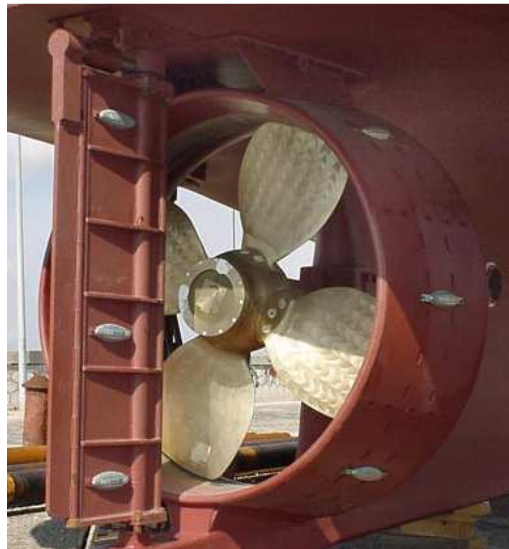
Figura 16: Hélice con sistema de tobera
