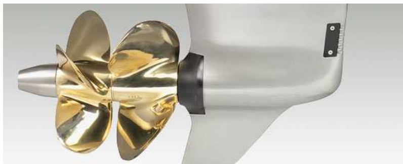
Figura 24: Hélice contrarrotativa Duoprop
