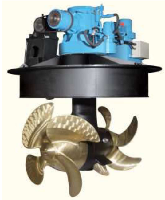
Figura 20: Conjunto de hélice doble
