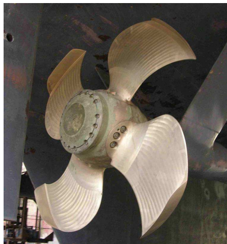
Figura 22: Hélice CLT instalada en buque
