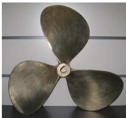
Figura 5: Hélice de tres palas
