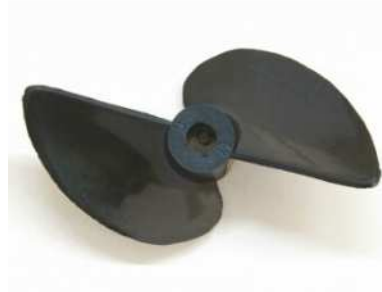
Figura 13: Hélice de carbono
