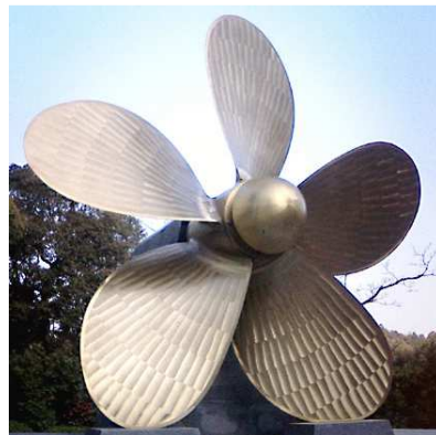
Figura 7: Hélice de cinco palas
