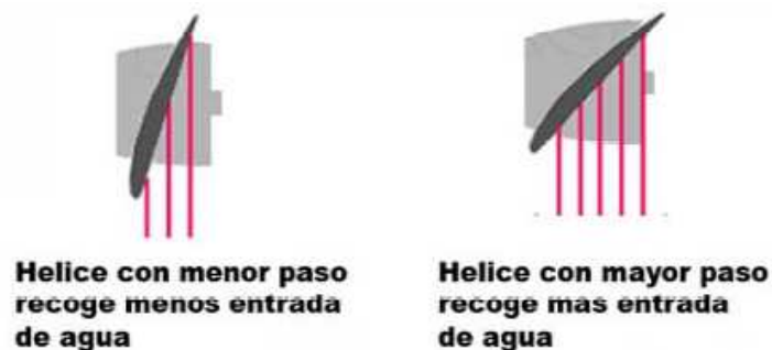
Figura 39: Diferentes flujos de agua con diferente rake
