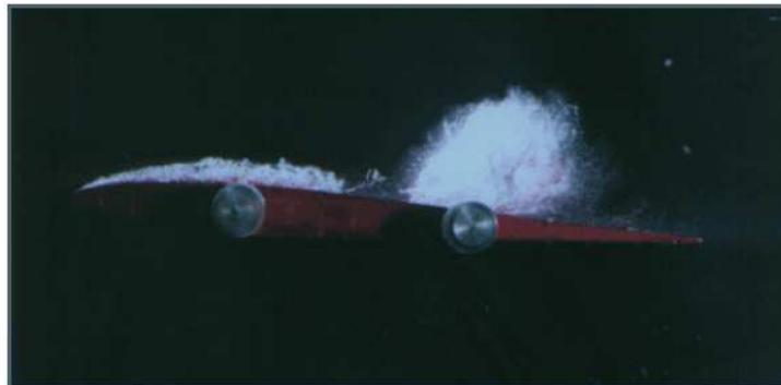
Figura 44: Cavitación de lámina y de nube
