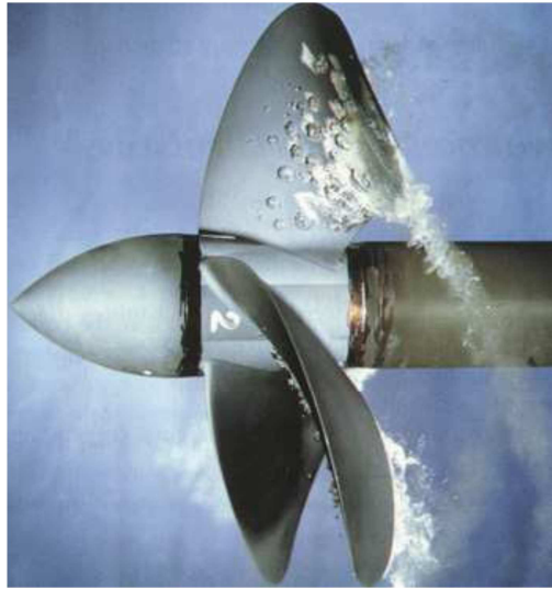
Figura 41: Aparición de burbujas de cavitación en las palas de una hélice
