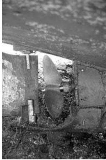
Figura 34: Ejemplo 3 de hélice mal instalada
