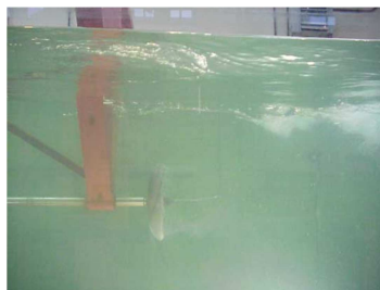
Figura 62: Hélice marina en el banco de ensayos
