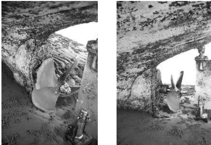
Figura 35: Ejemplo 4 de hélices mal instaladas (fotos de diferente ángulo)
