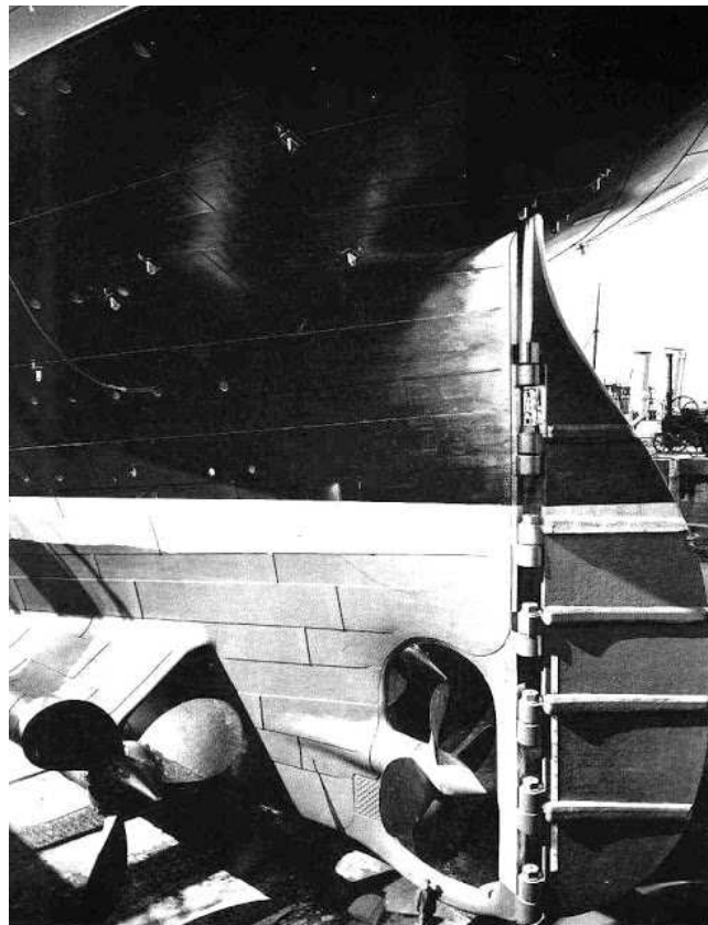
Figura 14: Hélices de paso fijo
