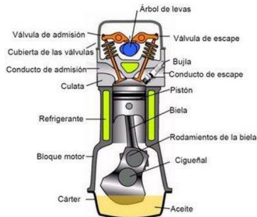
Fig. J.1 Partes motor de cuatro tiempos
