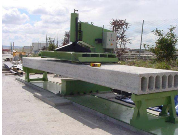
Figura 1.4 – Banc d'assaig a flexió de 50 Tm
