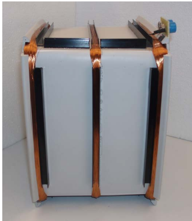
Figura 5.14 – Perfil de la bobina per mesurar provetes de formigó
