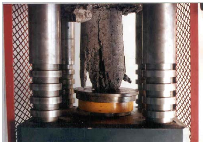
Figura 1.5 – La proveta s'ha sotmès a un assaig destructiu
