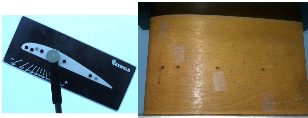
Fig. 5. Perfil Clark Y amb un angle d'inclinació de 30^\circ . Els fils de la superfície mostren clarament el despreniment del flux d'aire.
