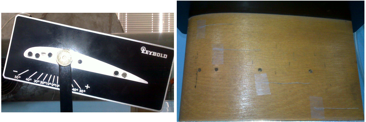
Fig. 3. Perfil Clark Y amb un angle d'inclinació a 15^\circ . Observant el fils existents a la superfície, el flux d'aire segueix adherit al perfil.
