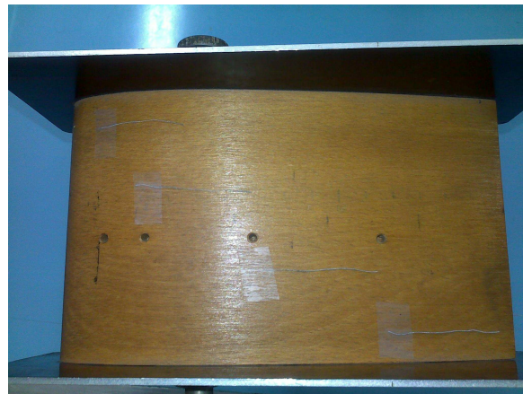
Fig. 1. Perfil Clark y amb un angle d'inclinació de 0°. Els fils situats a la superfície mostren que no existeix despreniment del flux d'aire.
