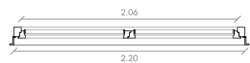
FINESTRA FE1 02 U (228x126) MATERIAL : ALUMINI VIDRE 3+3/6/3+3 AGAFADORS/PANY : MANETES OBERTURA : 2 FULLES OSCILLOBATENTS 1 FULLA FIXA
