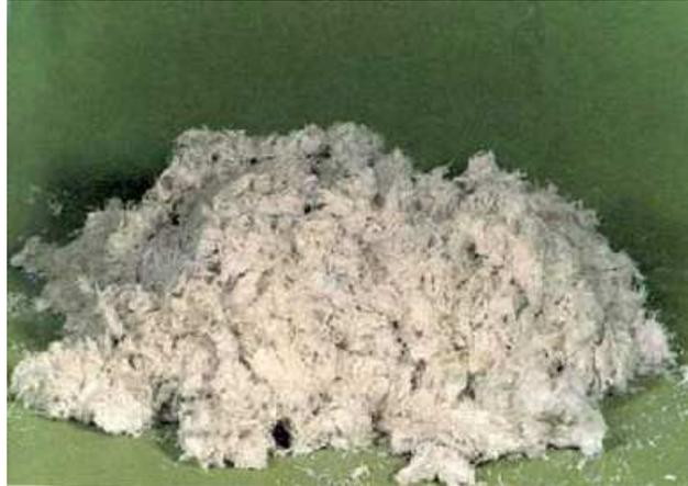
Figura 6.2: Fibras sueltas (Fuente: pág. 62 Guía Técnica del RD 396/2006 del INSHT)
