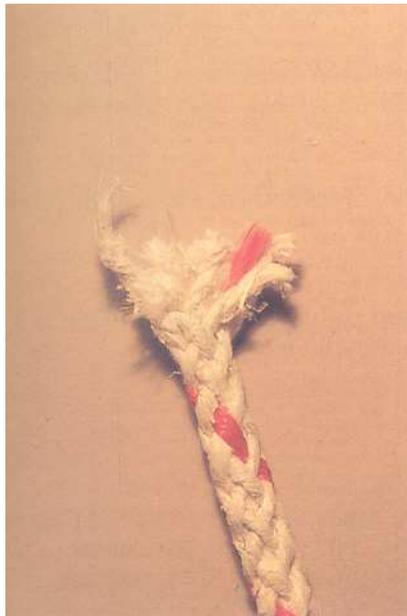
Figura 6.10: Cordón trenzado para juntas de calderas de calefacción. (Fuente: Manual per a la diagnosi i el tractament de l'amiant a la construcció, Ramón Graus [et al.], CAATB, BCN, 1998, pág. 19).
