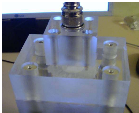
Fig. 4.19. Ensamblado del bloque superior a través de los tubos pasantes para acabar de configurar el montaje completo que se ha denominado cámara de ensayo.
