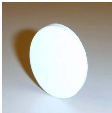
Fig. 4.21. Pastilla de cemento de sulfato de calcio fraguado después del ensayo
