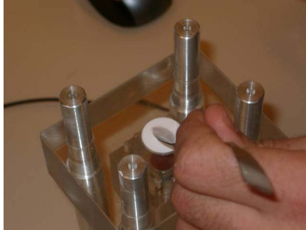
Fig. 4.18. Colocación de la pasta en el orificio central de la pieza de ensayo.
