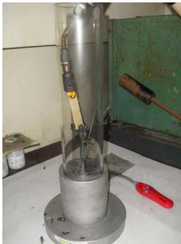
Figura 5.9 Ensayo de L.O.I.
