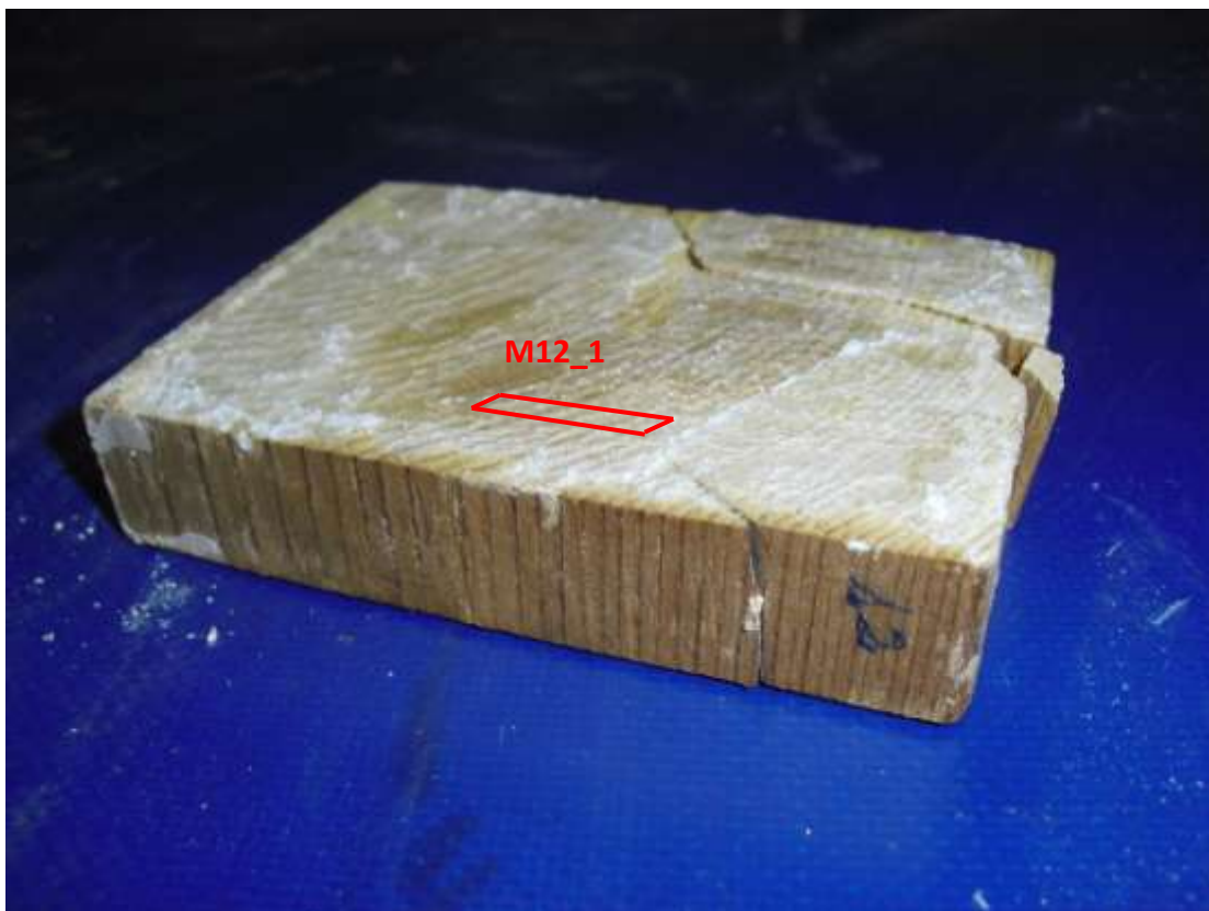
Figura 4.10 Muestra M12 impregnada con Solubor y KSil
