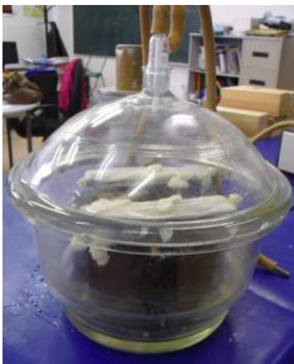
Figura 3.8 Campana con jaula, 6 muestras y pesos encima
