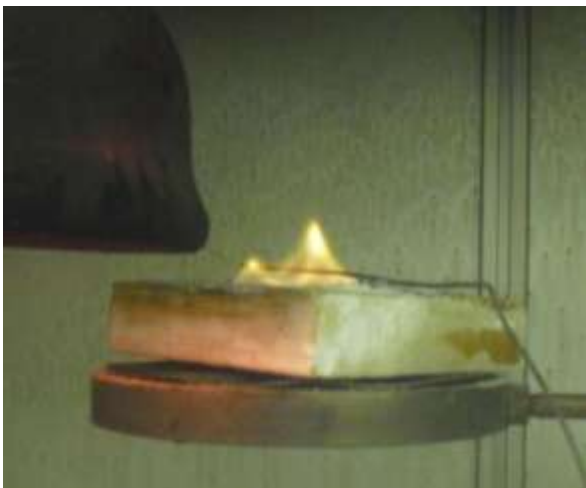
Figura 5.3 Muestra M82, Impregnada con Solubor y NaSil
