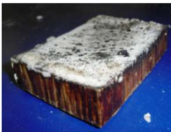
Figura 5.4 Muestra M51, Impregnada doblemente con KSil
