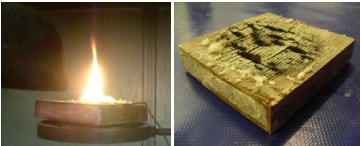
Figura 5.2 Muestra M93, Impregnada doblemente con NaSil
