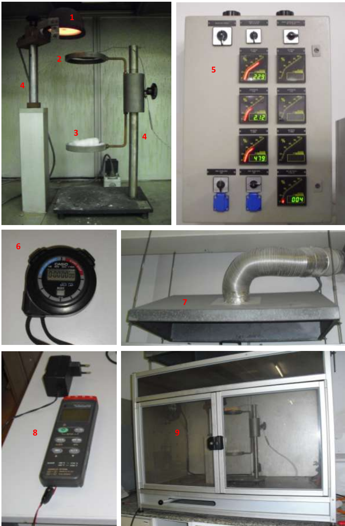
Figura 5.1 Detalles del equipo de Goteo
