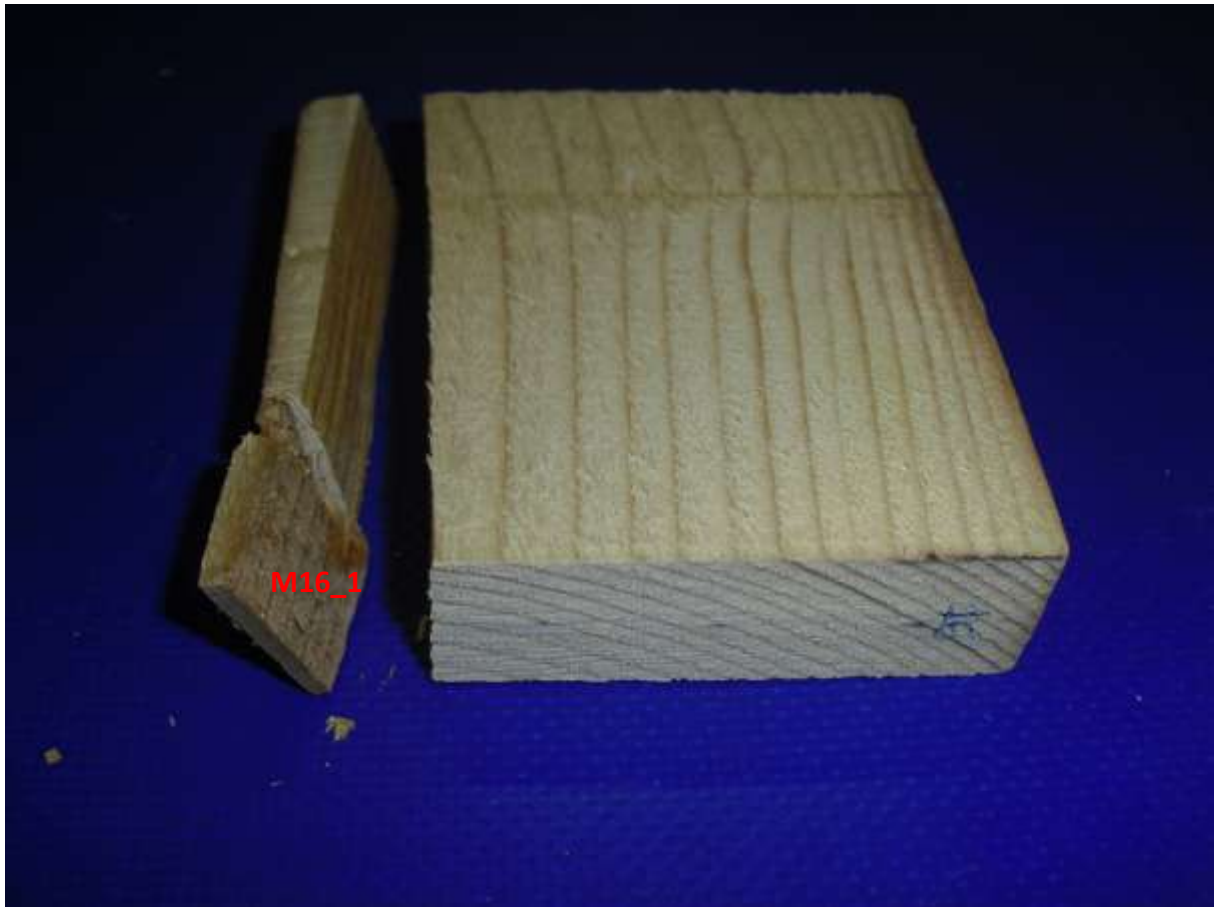
Figura 4.8 Muestra M16 impregnada con Solubor
