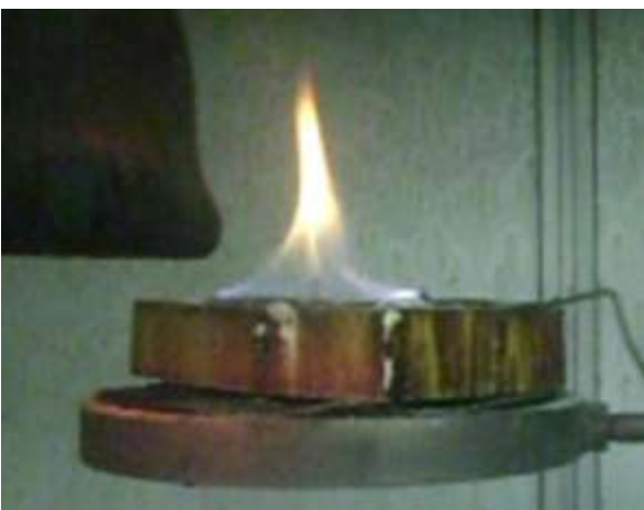
Figura 5.4 Muestra M51, Impregnada doblemente con KSil
