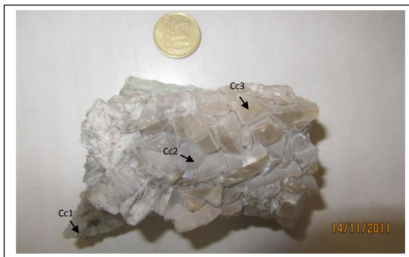
Fig. 20. Mostra amb tres tipus de calcita diferent que han crescut l'una sobre l'altre.
