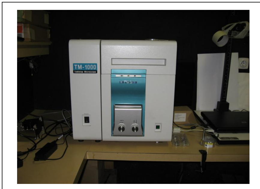
Fig. 4. Aparell de microscòpia electrònica de sobretaula amb anàlisi puntual (SEM) Hitachi TM-10000.
