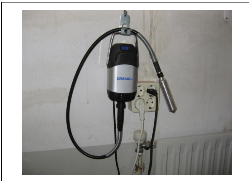
Fig 6. Trepant de dentista Dremel amb el que s'han fet les incisions a la calcita i als sulfurs.
